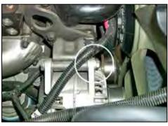
18. Remove the upper alternator bolt.
