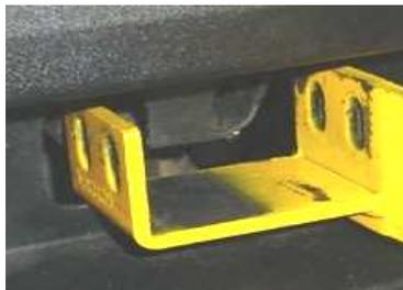
5. Fije el bracket al chasis usando los tornillos de fabrica que fijan al gancho de arrastre. No apriete aun, repita para el lado contrario.
