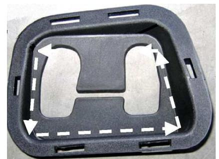
4. Introduzca el bracket por donde sale el gancho de arrastre, para colocarlo abrazando el chasis. Reinstale el gancho de arrastre
