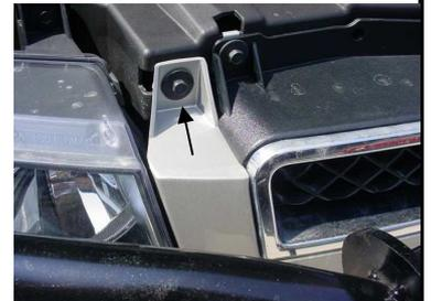
10. Sujete el Euroguard al bracket superior con los tornillos superiores preinstalados, rondana plana y tuerca de seguridad de color negro. Procure que la tuerca quede del lado del cubrefaro.
