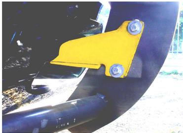
9. Sujete el bracket superior como muestra la imagen, utilizando el tornillo removido en el paso anterior.
