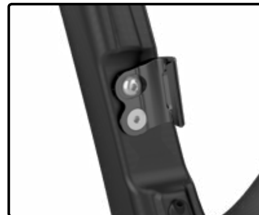
6. Derailleur hanger adjustment
