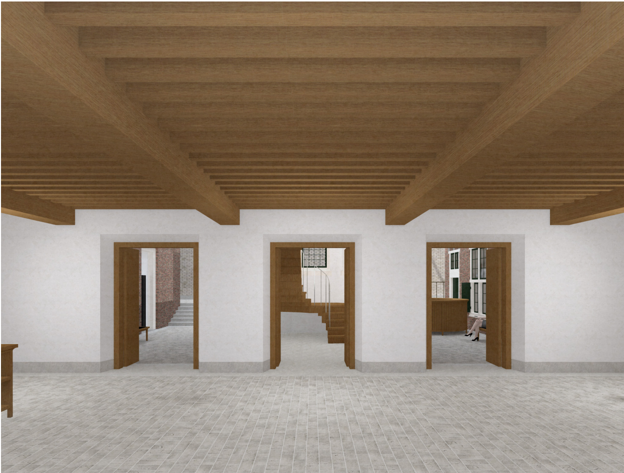
Visualisatie van de Achterplaets vanuit de vestibule Door trapelement in het middendeel moeten bestaande raamopeningen tot deuren vermaakt worden. Hiertoe wordt oorspronkelijk 17e eeuws weefsel weggenomen.
