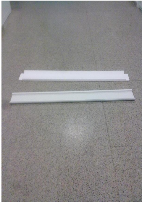
Detalle tapa de registro con poliespan
