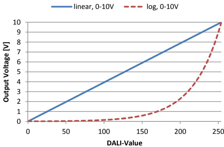
**Ausgangsspannung 0-10V bzw. 0-100%:**
