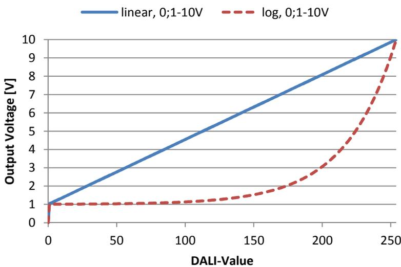
**Ausgangsspannung 1-10V bzw. 10-100%:**
