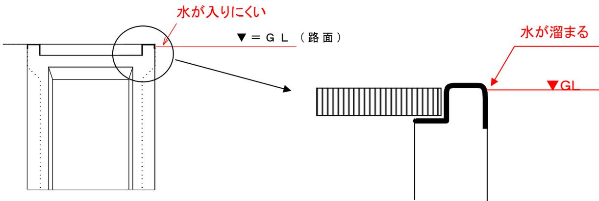
従来型の柵は、四面の鋼板が、折り曲げの受枠になっているため
