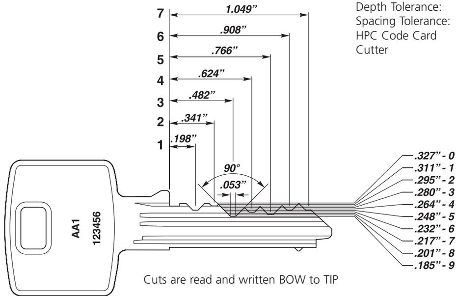
Plug Diameter: 0.496" Pin Diameter: 0.112"
