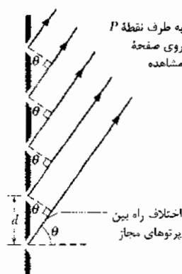
شکل ۳۶-۲۰ پرتوهای حاصل از شیارهای یک توری پراش تا نقطه دور P تقریباً موازی‌اند. اختلاف راه بین هر دو پرتو مجاور d \sin \theta است، که \theta به صورتی که نشان داده شده است اندازه‌گیری می‌شود. (شیارها به سمت داخل و خارج صفحه کاغذ ادامه دارند).
