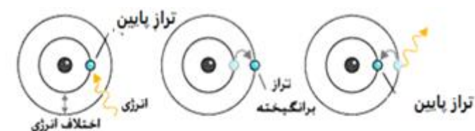
شکل ۵ انتقال الکترون را از یک مدار به مدار دیگر نشان می‌دهد
