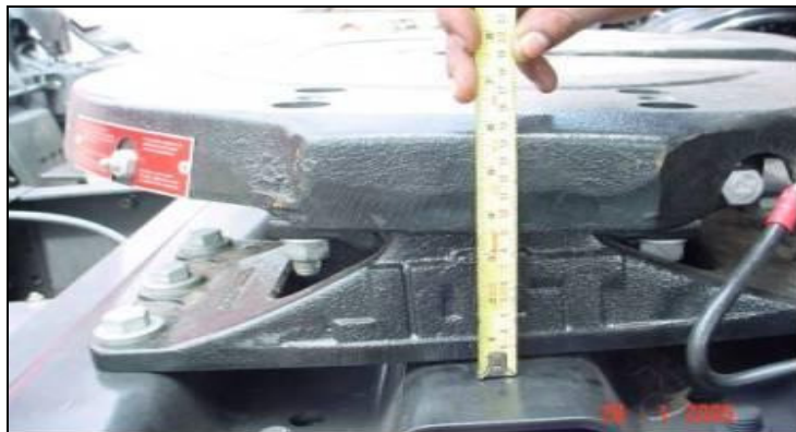
Figura 14 – Redução da altura do perfil do engate sobre o chassi encurtado do cavalo modelo 1728
