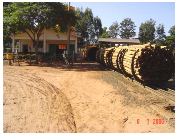
Foto 02: Madeira preparada para tratamento no processo de osmopressurização. Fonte: Cocamar Cooperativa Agroindustrial, 2007
