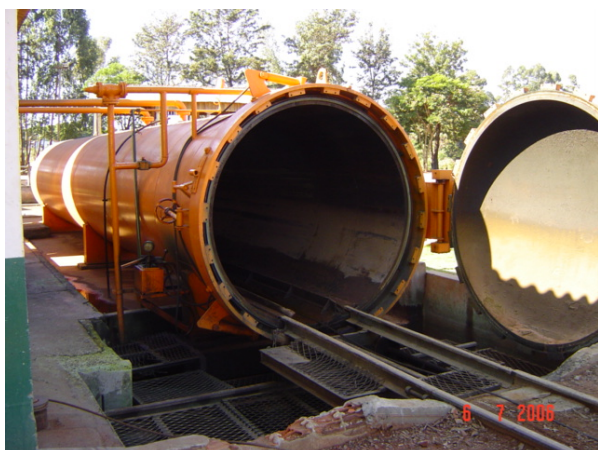
Foto 03: Auto-clave utilizado para tratamento da madeira. Fonte: Cocamar Cooperativa Agroindustrial, 2007
