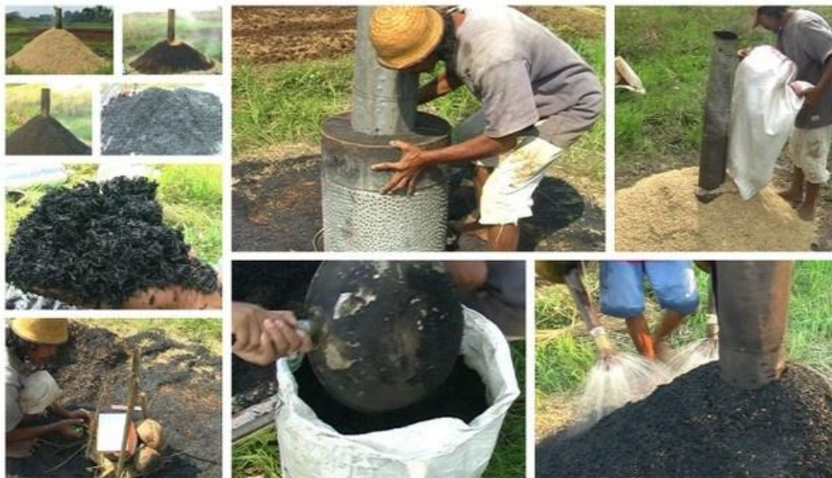
Gambar 2.6 Proses Pembuatan Briket Batubara dari Sekam Padi
