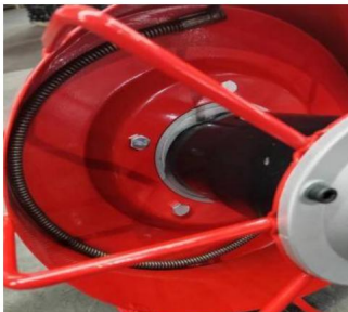
De veer in de trommel is in de gewenste richting gewikkeld
