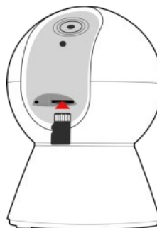
Rysunek 1: Ostrożnie wsadź kartę microSD
