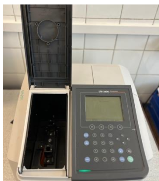
Rys.3. Zastosowany spektrofotometr UV-Vis wraz z próbką
