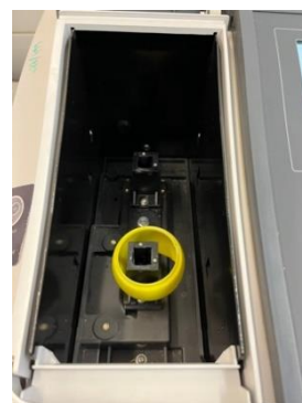
Rys.3. Zastosowany spektrofotometr UV-Vis wraz z próbką
