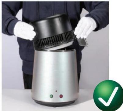
• Verwijder het bovenste deksel 15 minuten na het stoppen van de distillatie
