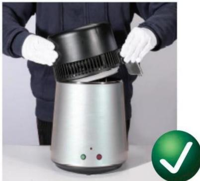
Retire la tapa superior 15 minutos después de detener la destilación.
