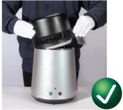
ö Ta bort det övre locket 15 minuter efter att destillationen stoppats
