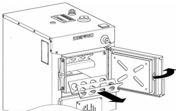
KROK 1. Otworzyć drzwi wyczystne i wyjąć dolny zawiórywacz.
