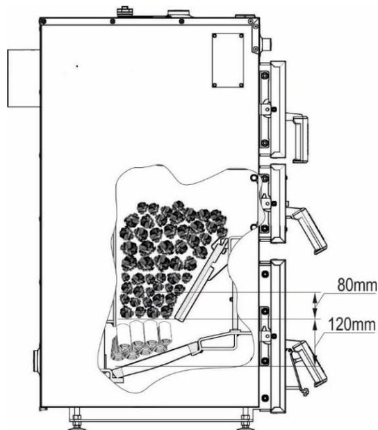
Rysunek 14. Prawidłowe ułożenie paliwa w komorze paleniskowej.
