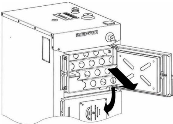
**KROK 2.** Ostrożnie odchylić górny zawirywacz wysunąć. Oczyszczyć zawirywacze oraz powierzchnię wymiany ciepła. Zamontować w odwrotnej kolejności.
