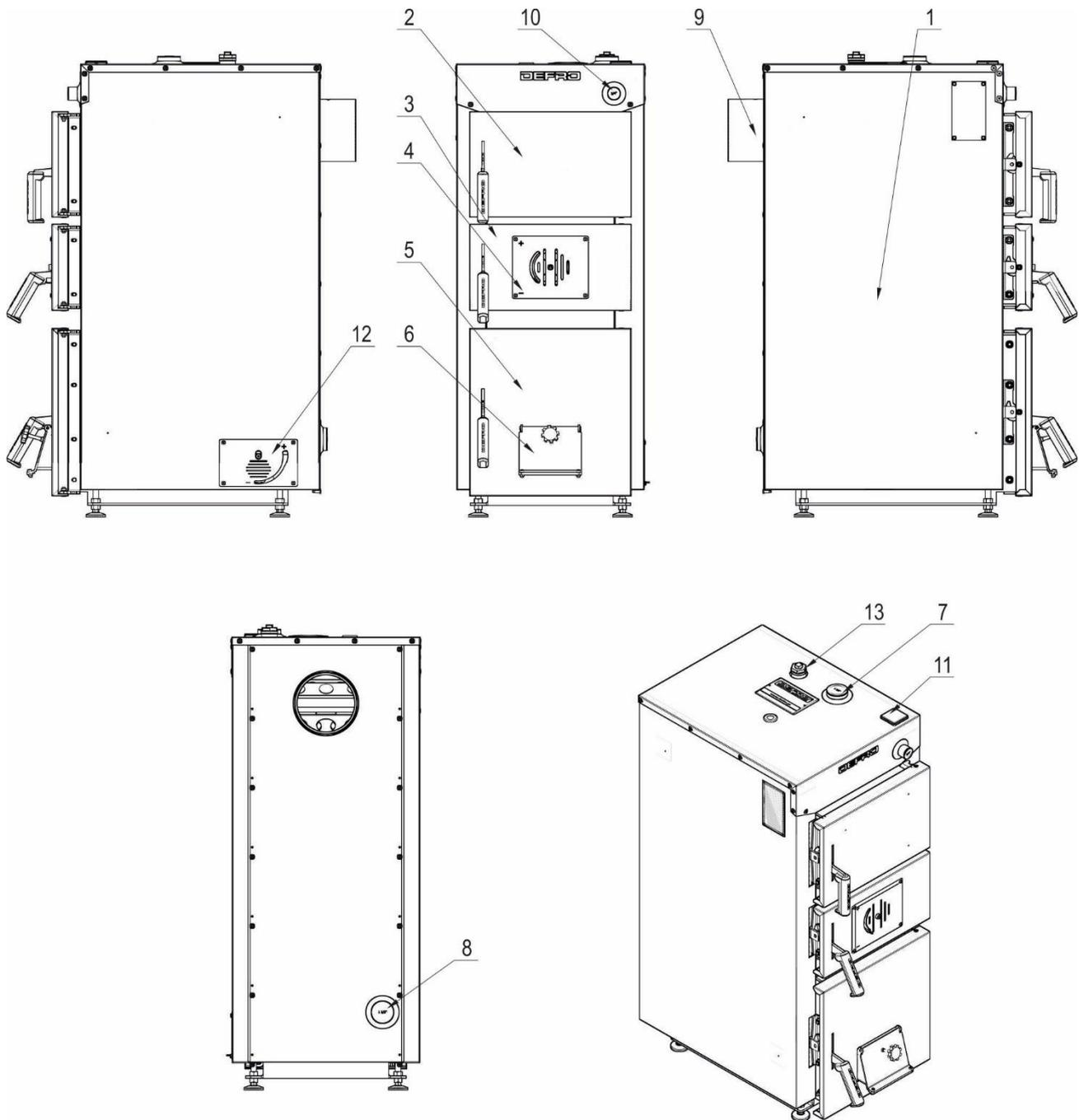
Rysunek 3. Podstawowe elementy kotła OPTIMA KOMFORT EKO
