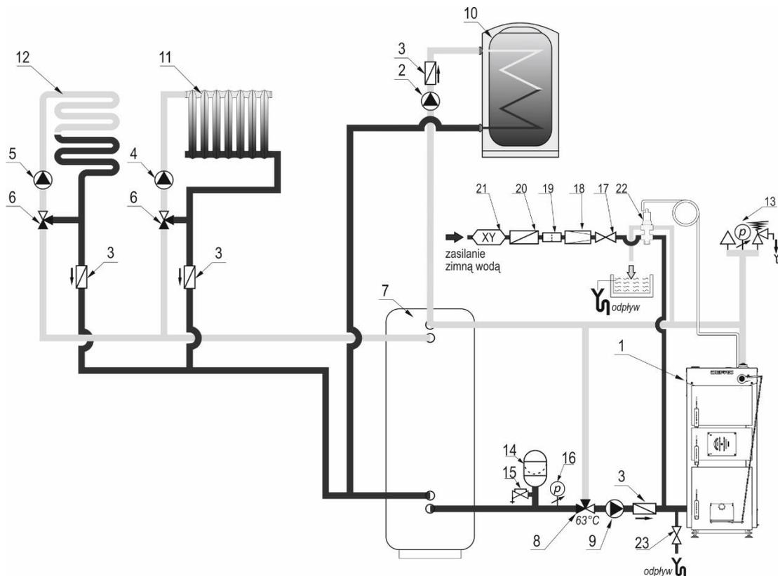
Rysunek 9. Uproszczony schemat instalacji grzewczej systemu zamkniętego.
