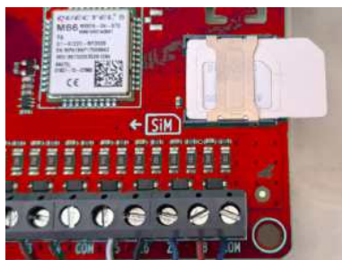
Rysunek 4: Instalacja karty SIM w PRiMA64Q/PRiMA16Q.
