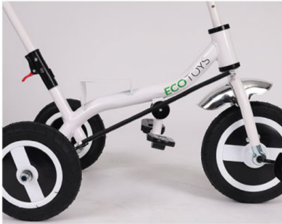
12. Properly installed steering cable 12. Steuerkabel richtig montiert
