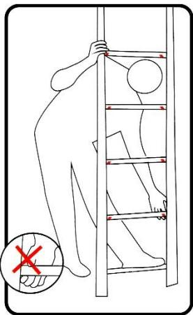
**4.** Stoupněte si jednou nohou na nejnižší příčku, uchopte boční tyč jednou rukou a druhou rukou stiskněte současně levý a pravý zajišťovací mechanismus dané příčky. **Upozornění:** Nedávejte ruce přímo na příčku při stisknutí zajišťovacích tlačítek – hrozí skřípnutí prstů!
