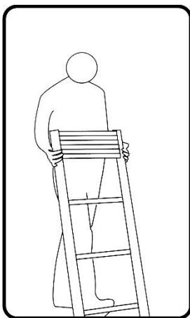
**2.** Umístěte žebřík na zem, stoupněte si jednou nohou na spodní příčku a oběma rukama vytahujte horní část směrem nahoru až do požadované výšky.
