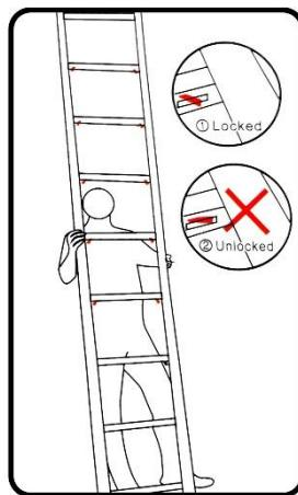
**3.** Před použitím vždy zkontrolujte, zda jsou všechny příčky správně zajištěné (viz obrázek). Správně uzamčená příčka je bezpečně fixovaná. Žebřík má být při použití nakloněn přibližně v úhlu 75° vůči zemi.
