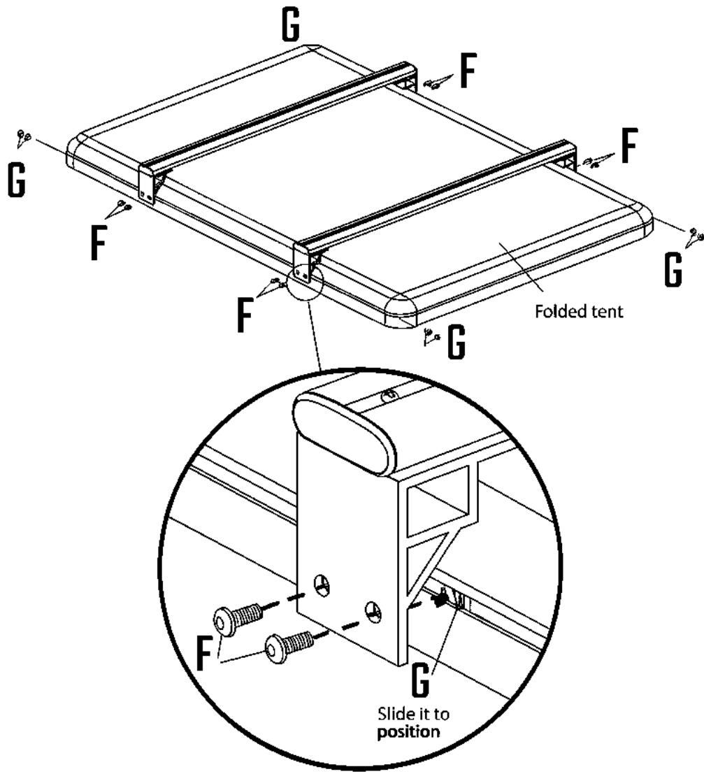
Pokud je to nutné - uhládte drážky, do kterých budete vkládat matice pomocí pilníku či nože. Tak aby šli vložit matičky, vložte matičky do uzavřené konstrukce stanu tak aby byli od sebe na vzdálenost děr v držáku. Přišroubujte držák pomocí šroubků ke konstrukci stanu.
