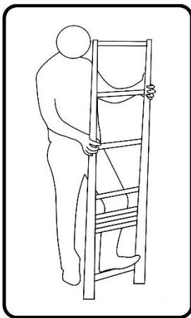
**5.** Při stisknutí zajišťovače se příčky automaticky začnou zasouvat směrem dolů. Pokračujte postupně příčku po příčce.
