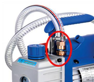
4 . Gränssnittet på de Övrig slutet av de slang är anslutet till de Vakuum mätare och de ventil växla är visas i figuren
