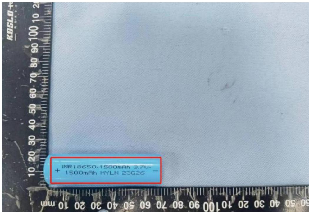
Rysunek 1 Wygląd produktu (IMR18650-1500mAh) (Czerwona ramka pokazuje lokalizację tabliczki znamionowej)
