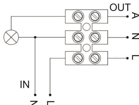
A - Napięcie wyjściowe/ Output voltage/Ausgangsspannung/ Tension de sortie/
