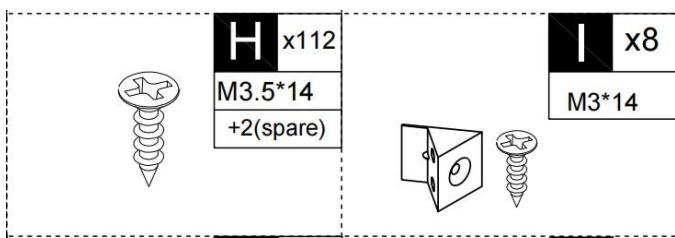
**DE:** Bitte beachten Sie, dass die Formen der Schrauben H und I ähnlich sind. Bitte installieren Sie entsprechend der Anleitung und unterscheiden Sie sie!
