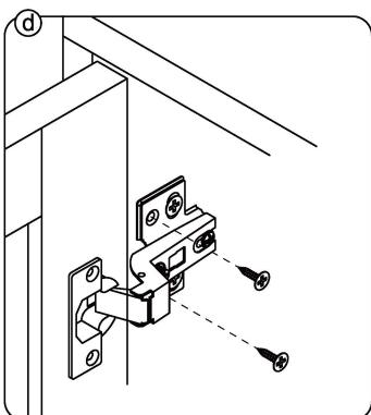
**DE:**Vor dem Einbau die Schrauben in die Löcher stecken und festziehen, aber nicht bis 100 %, 70% bis 80% anziehen reicht aus. Schließlich, nachdem alle Schrauben installiert sind, ziehen Sie alle Schrauben auf 100%.
