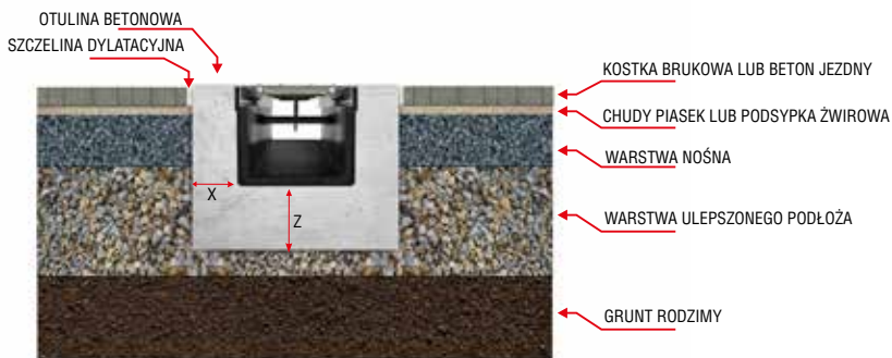
Wielkości ławy betonowej zależnie od klasy obciążenia
