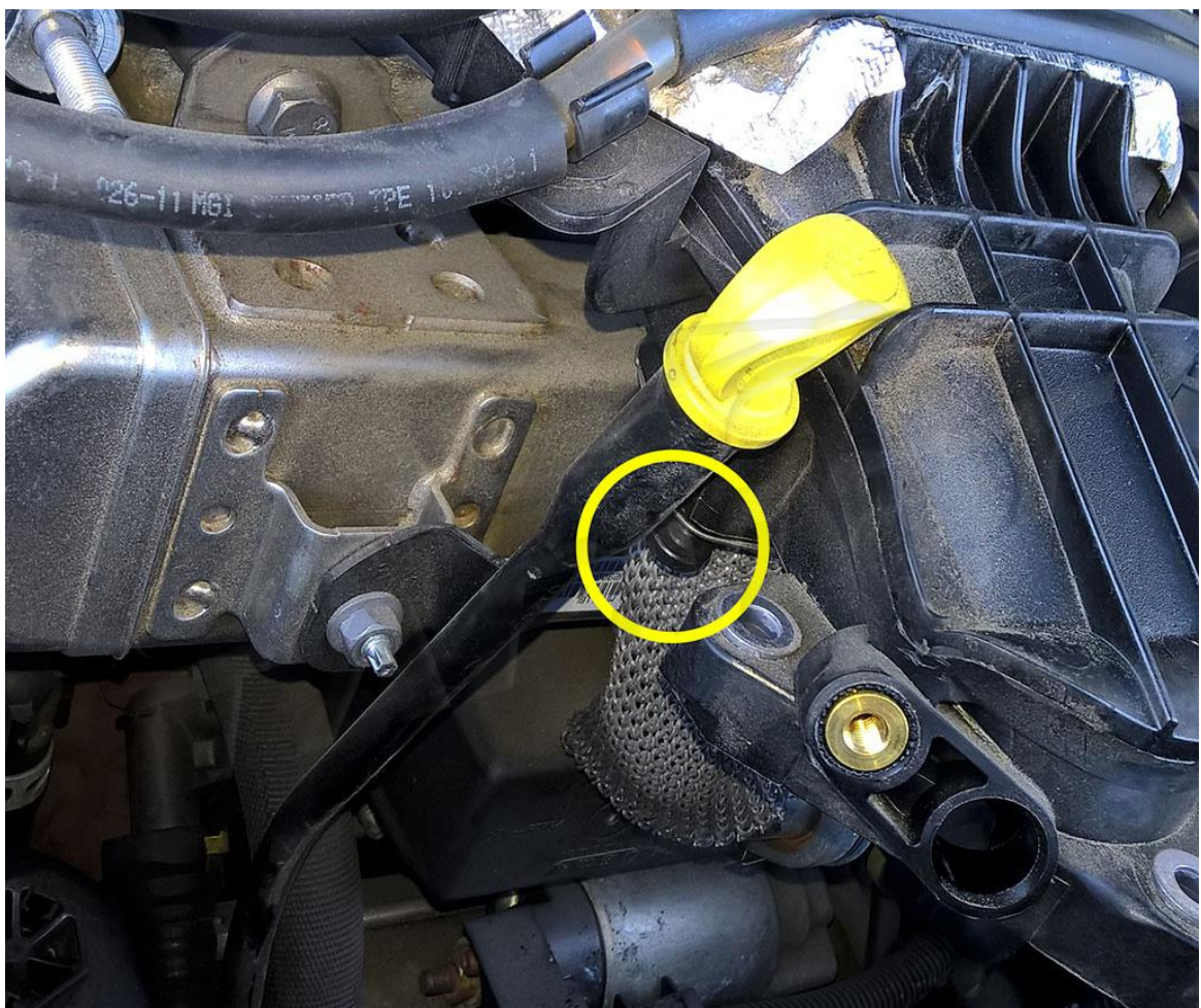
Śruba do odkręcenia – Torx – tutaj lekko odkręcona, by była dobrze widoczna
