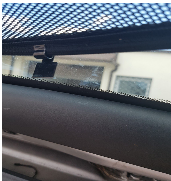
Rys.10 - sposób zamocowania zaczepu w klapie bagażnika
