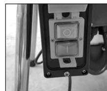
7. Interruptor de encendido (verde) / interruptor de apagado (rojo) (no incluidos en la primera ilustración)
