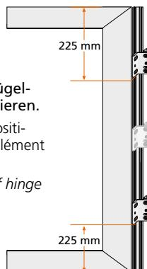
Bohrlehre für Flügel in Beschlagnut einsetzen – Pfeil zeigt Richtung Oberkante Türflügel. Markierung Bohrlehre stimmt mit Markierung Türflügel überein. Oberste Bohrung setzen.
