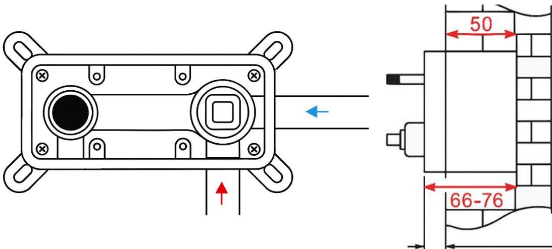
Całkowita wysokość warstwy wykończeniowej (np. płytki) powinna mieścić się w zakresie 66–76 mm od podstawy boxa montażowego .
