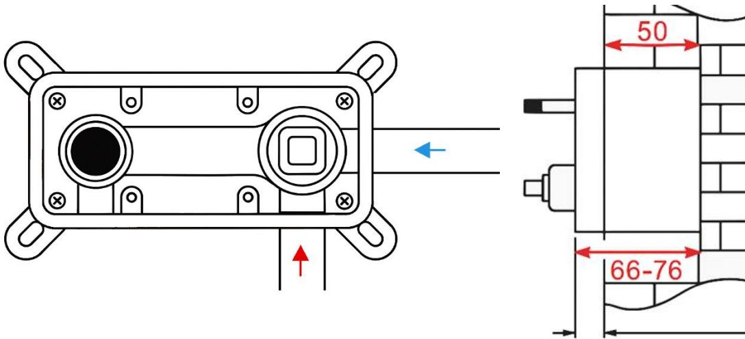
L'épaisseur totale de la couche de finition (par exemple, le carrelage) doit être comprise entre **66 et 76 mm** à partir de la base du boîtier de montage.
