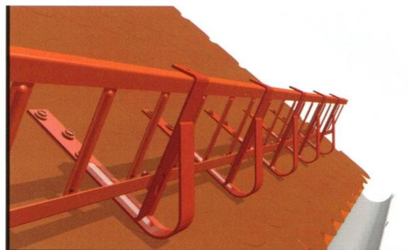
Po upevnení požadovaného počtu držiakov U je treba namonto- vať protisnehový plot. Plot montujeme v držiaku pomocou zápa- diek. Posledná etapa je kontrola riadnej montáže, najmä stability všetkých mechanických spojov.
