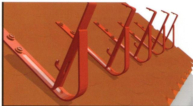
Úchyt (typ U) je treba uložiť na skôr vykonanej plochej strešnej krytine (napr. šindel, lepenka) a priskrutkovať priamo k drevenej konštrukcii strechy. Vzdialenosť držiakov závisí na zóne zaťaže- nia snehom (max. každých 40 cm. - v IV. a V. zóne a max. každých 60 cm - v I., II., III. zóne). Množstvo držiakov je treba prispôsobiť vlastným potrebám.
