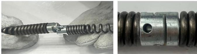
2. Förberedelse innan du använder 3/8"-fjädrar för att rensa rörledningen. Se till att strömbrytaren är i OFF-läge. Dra ut fjädern från
