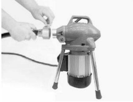
(5) Retirez une section (ou moins de 5 mètres) du ressort du panier à ressort, sortez la clé utilisée pour retirer le ressort du sac à outils, insérez-la dans le trou du joint à ressort et poussez-la avec force le long de la fente de connexion du joint pour retirer le ressort. (Comme indiqué sur la figure)
