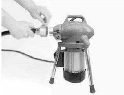
(5) Ziehen Sie ein Stück (oder weniger als 5 Meter) der Feder aus dem Federkorb, nehmen Sie den Schlüssel zum Entfernen der Feder aus der Werkzeugtasche, stecken Sie ihn in das Loch der Federverbindung und drücken Sie ihn kräftig entlang des Verbindungsschlitzes der Verbindung, um die Feder zu entfernen. (Wie in der Abbildung gezeigt)
