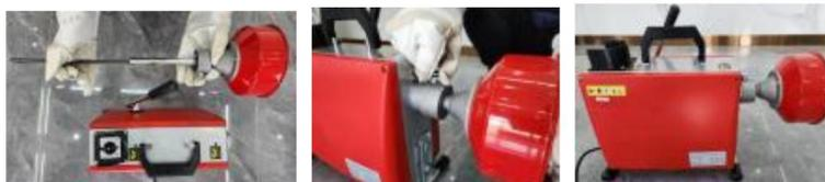
3. Coloque la máquina a una distancia de 1 a 2 pies de la entrada de la tubería, ya que una distancia excesiva puede provocar que los cables de acero se enreden.
