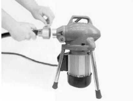
(5) Trek een deel (of minder dan 5 meter) van de veer uit de veermand, pak de sleutel die is gebruikt om de veer uit de gereedschapstas te verwijderen, steek deze in het gat van de veerverbinding en duw deze krachtig langs de verbindingsgleuf van de verbinding om de veer te verwijderen. (Zoals weergegeven in de afbeelding)
