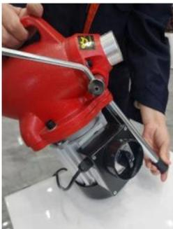
2. Fixez la poignée d'embrayage 100, ouvrez l'emballage et retirez la machine, retirez le sac à poussière, ouvrez l'emballage de la tête de dragage, retirez l'hexagone clé et serrez la vis pour fixer la poignée d'embrayage avec la clé hexagonale poignée.(comme indiqué sur la figure)
