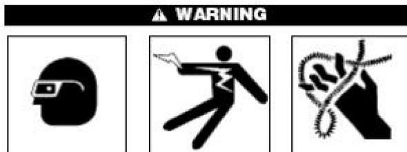
Utilice siempre gafas de seguridad, guantes de dragado y otros dispositivos de protección adecuados, como dispositivos de protección química, usando una capa de guantes protectores contra líquidos, etc.
