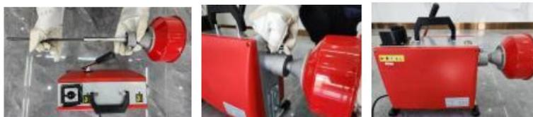
3. Placera maskinen 1-2 fot bort från rörledningens inlopp, eftersom för stort avstånd kan orsaka att stålkablar trasslar in sig.
