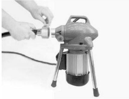
(5) Wyciągnij część (lub mniej niż 5 metrów) sprężyny z koszyka sprężyny, wyjmij klucz używany do wyjmowania sprężyny z torby narzędziowej, włóż go do otworu złącza sprężyny i mocno popchnij wzdłuż szczeliny połączenia złącza, aby wyjąć sprężynę. (Jak pokazano na rysunku)
