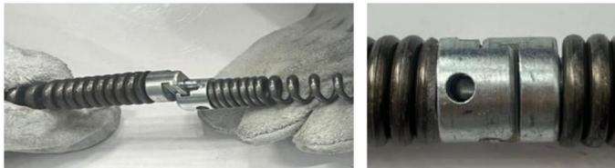
2. Préparation avant d'utiliser des ressorts de 3/8" pour dégager la canalisation Assurez-vous que l'interrupteur est en position
