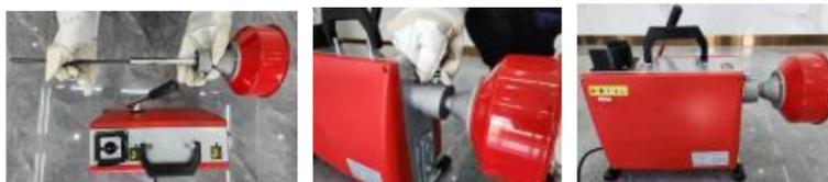
3. Placez la machine à 1 à 2 pieds de l'entrée du pipeline, car une distance excessive peut entraîner l'enchevêtrement des câbles en acier.
