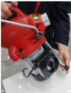
2. Fissare la maniglia della frizione 100, aprire la confezione e rimuovere la macchina, rimuovere il sacchetto antipolvere, aprire la confezione della testa di dragaggio, estrarre l'esagono chiave inglese e stringere la vite per fissare la maniglia della frizione con la chiave esagonale maniglia.(come mostrato nella figura)
