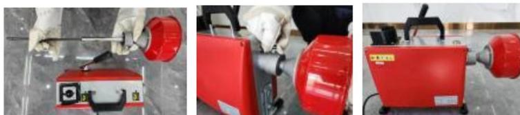
3. Platzieren Sie die Maschine 30–60 cm vom Einlass der Rohrleitung entfernt, da sich bei zu großer Entfernung die Stahlkabel verwickeln können.
