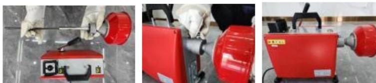
3. Plaats de machine op 30-60 cm afstand van de inlaat van de pijpleiding, omdat een te grote afstand ertoe kan leiden dat stalen kabels in de knoop raken.
