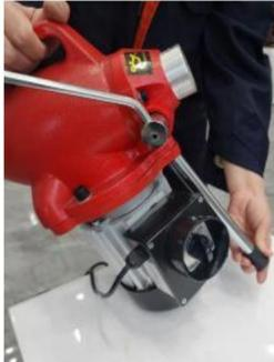
2. Befestigen Sie den 100-Kupplungsgriff, öffnen Sie die Verpackung und entnehmen Sie die Maschine, entfernen Sie den Staubbeutel, öffnen Sie die Baggerkopfverpackung, nehmen Sie den Sechskant heraus Schraubenschlüssel und ziehen Sie die Schraube fest, um den Kupplungsgriff mit dem Sechskant zu fixieren Griff (wie in der Abbildung gezeigt)
