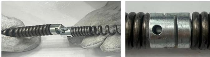
2. Przygotowanie przed użyciem sprężyn 3/8" do czyszczenia rurociągu
