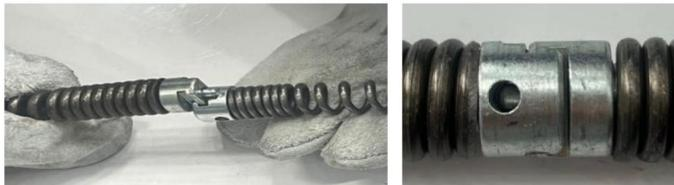
2. Vorbereitung vor der Verwendung von 3/8-Zoll-Federn zum Reinigen der Rohrleitung
