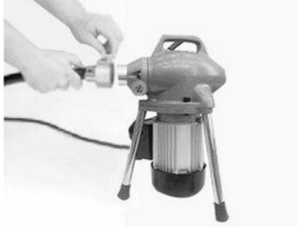
(5) Estrarre una sezione (o meno di 5 metri) di molla dal cestello della molla, estrarre la chiave utilizzata per rimuovere la molla dalla borsa degli attrezzi, inserirla nel foro del giunto della molla e spingerla con forza lungo la fessura di collegamento del giunto per rimuovere la molla. (Come mostrato nella figura)
