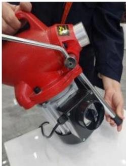
2. Bevestig de 100 koppelingshendel, open de verpakking en verwijder de machine, verwijder de stofzak, open de baggerkopverpakking, haal de zeshoekige sleutel en draai de schroef vast om de koppelingshendel met de zeskant vast te zetten handvat.(zoals weergegeven in de afbeelding)
