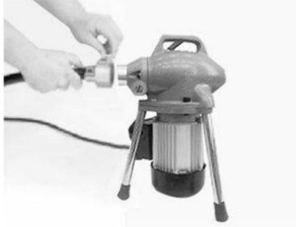
(5) Dra ut en del (eller mindre än 5 meter) av fjädern från fjäderkorgen, ta ut nyckeln som användes för att ta bort fjädern från verktygsväskan, för in den i hålet i fjäderleden och tryck den med kraft anslutningslitsen på leden för att ta bort fjädern. (Som visas på bilden)
