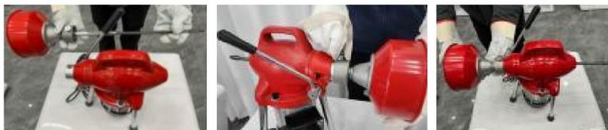
Zamontuj komorę sprężynową typu GQ-100 (jak pokazano na rysunku)
