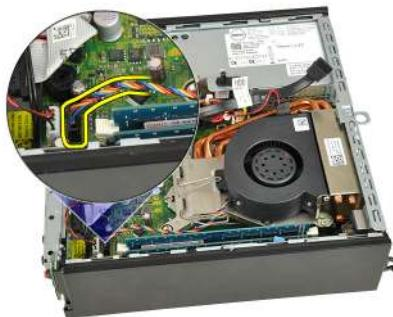
6. Naciśnij dźwignię zwalniającą, a następnie pociagnij ją na zewnątrz, aby uwolnić ją spod zaczepu, który ją zabezpiecza.
