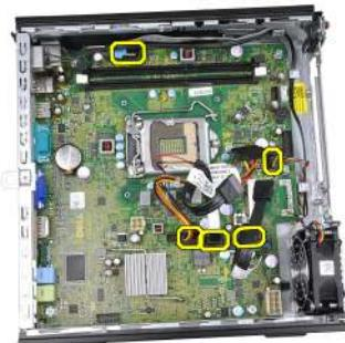
12. Lösen Sie die interne Antenne und nehmen Sie sie aus dem Gehäuse.
