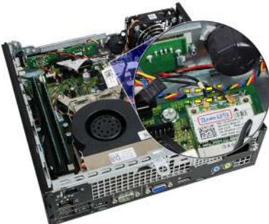
7. Entfernen Sie die Schrauben, mit denen der Lüfter am Gehäuse befestigt ist.
