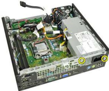
10. Schieben Sie das Netzteil nach innen und entfernen Sie es.
