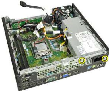
10. Napájací zdroj posuňte smerom dovnútra a vyberte napájací zdroj.
