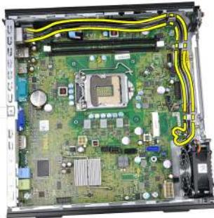
13. Entfernen Sie die Schrauben, mit denen die Systemplatine am Gehäuse befestigt ist.
