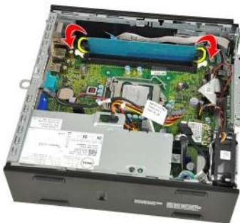
6. Uvoľnite pamäťový modul z konektora na systémovej doske a vyberte ho.
