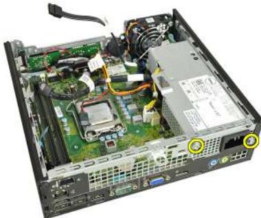
10. Zasuňte napájecí zdroj dovnitř a vyjměte jej.
