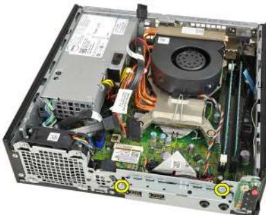
7. Wyjmij panel we/wy z ramy montażowej.
