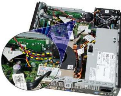
7. Lösen Sie den Riegel und drehen Sie den Lautsprecher.
