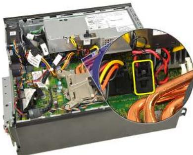
6. Posuňte spínač vniknutia a vyberte ho z konzoly.
