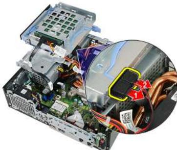
6. Odpojte údajový kábel a napájací kábel zo zadnej časti pevného disku.
