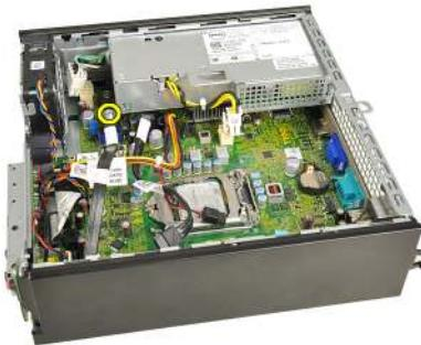
9. Lösen Sie die Schrauben, mit denen das Netzteil am Gehäuse befestigt ist.
