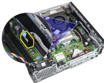
7. Válassza le a vezérlőpanelen található hangszóró kábelét a házon lévő kapocsról.
