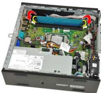
6. Heben Sie das Speichermodul aus dem Anschluss auf der Systemplatine und entfernen Sie es.
