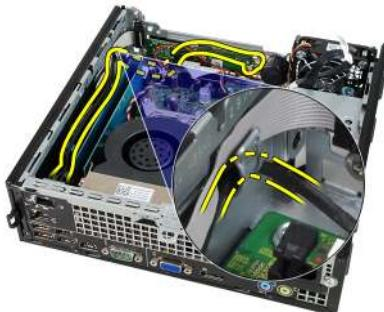
7. Lösen Sie den Anschluss der internen Antenne.
