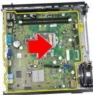
16. Wyjmij płytę systemową z ramy montażowej.
