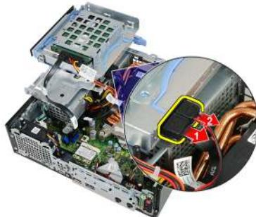
6. Ze zadní části pevného disku odpojte datový a napájecí kabel.
