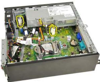
8. Távolítsa el a tápegységet a számítógépházhhoz rögzítő csavart.
