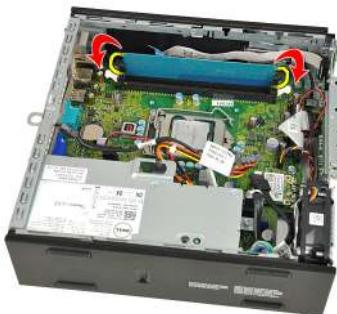
6. Wyjmij moduł pamięci ze złącza na płycie systemowej.
