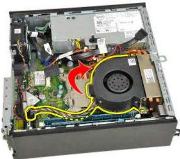
8. Lazítsa meg a hűtőborda egységet az alaplaphoz rögzítő rögzített csavarokat.
