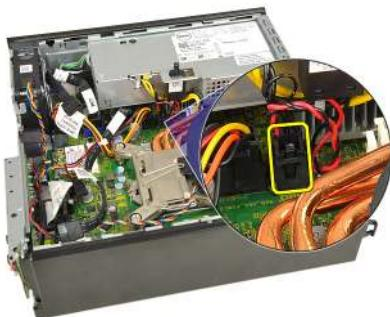
6. Przesuń przełącznik czujnika naruszenia obudowy i wyjmij go ze wspornika.
