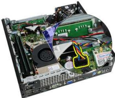
6. Uvolněte kabel systémového ventilátoru od skříně.
