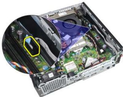
7. Wyjmij kabel panelu sterowania z zacisku na ramie montażowej.
