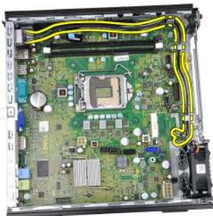
13. Wykręć wkręty mocujące płytę systemową do ramy montażowej.
