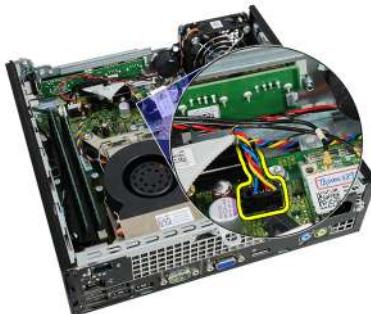
6. Válassza le a rendszerhűtő kábelét a számítógépházról.
