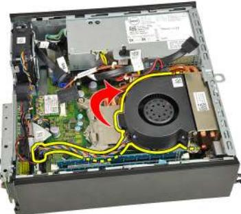
8. Uvoľnite záchytné skrutky a pripojte zostavu chladiča/ventilátora k systémovej doske.
