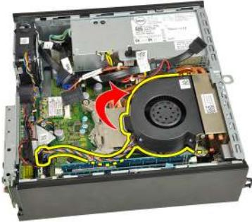
8. Lösen Sie die vier unverlierbaren Schrauben, mit denen die Kühlkörper-/Lüfterbaugruppe an der Systemplatine befestigt ist.
