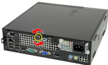
3. Csúsztassa a fedelet a számítógép hátsó része felé.
