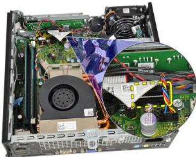
6. Entfernen Sie die Schrauben, mit denen die Eingabe/Ausgabe-Halterung befestigt ist.
