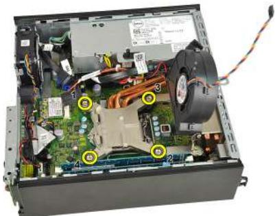
9. Unieś zespół radiatora i wentylatora i wyjmij go z komputera. Położ zespół wentylatorem ku dołowi, tak aby powierzchnia pokryta pastą termoprzewodzącą była skierowana do góry.
