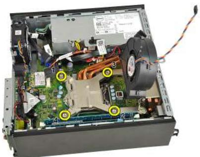
9. Nadvihnite zostavu chladiča/ventilátora a vyberte ju z počítača. Položte zostavu tak, aby ventilátor smeroval nadol a strana s termálnym tukom nahor.
