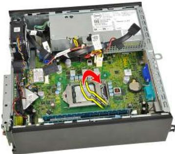
8. Heben Sie den Prozessor aus dem Sockel und verpacken Sie ihn in einer Antistatikverpackung.
