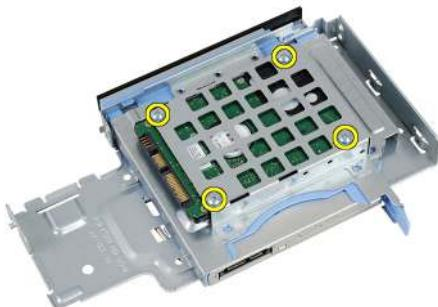
7. Posuňte pevný disk a vytiahnite ho z rámu diskovej jednotky.
