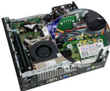
7. Távolítsa el a csavarokat, amelyek a ventilátort a számítógépházhhoz rögzítik.
