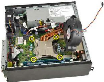
9. Emelje fel finoman a hűtőborda egységet, majd távolítsa el a számítógépből. Az egységet úgy helyezze el, hogy a ventilátor lefelé, a hővezető zsír pedig felfelé nézzen.
