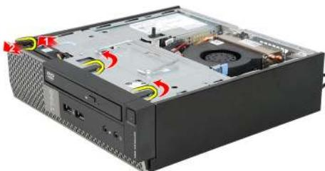
4. Az előlap szemközti oldalán lévő horgoknak a számítogéphásról történő leválasztásához fordítsa az előlapot a számítogéptől távolodó irányba.
