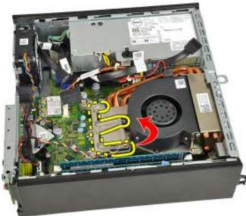
7. Heben Sie die Kühlkörper-/Lüfterbaugruppe an.
