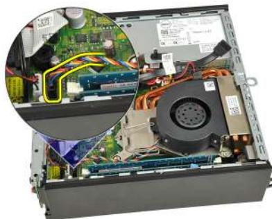
6. Zatlačte na uvolňovací páčku směrem dolů. Potom ji posuňte směrem ven a uvolněte ji z přidržovacího háčku.
