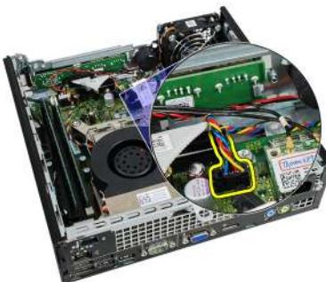
6. Oddel'te kábel ventilátora systému od skrinky.
