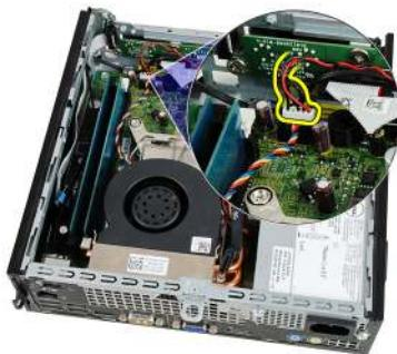
6. Ziehen Sie das Lautsprecherkabel unter dem Systemlüfterkabel und den WLAN-Antennen (falls eingebaut) hervor.
