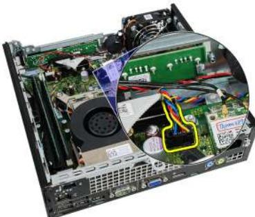
6. Wyjmij kabel wentylatora systemowego z zacisku na ramie montażowej.
