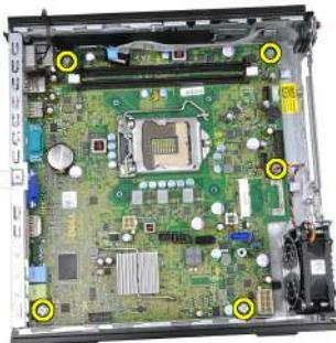
14. Entfernen Sie die 7-mm Sechskantschraube von der Systemplatine.
