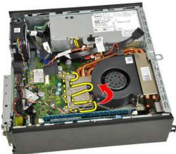
7. Emelje fel a hűtőbordát/ventilátor egységet.
