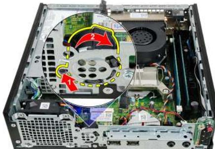
8. Entfernen Sie den Lautsprecher aus dem Gehäuse.
