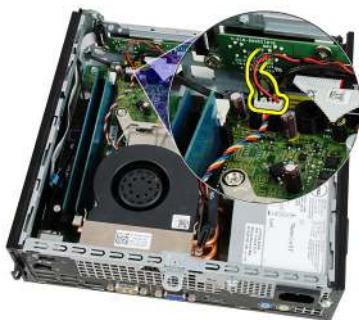
6. Vyberte kábel reproduktora spod kábla ventilátora systému a antén bezdrôtovej siete WLAN (ak sú nainštalované).
