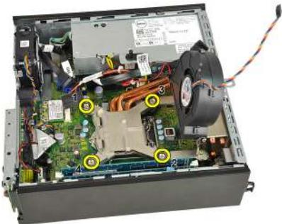
9. Heben Sie die Kühlkörper-/Lüfterbaugruppe an und entfernen Sie sie vom System. Legen Sie die Baugruppe mit nach unten gerichtetem Lüfter und nach oben weisender Wärmeleitpaste hin.
