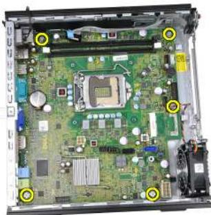
14. Wykręć wkręt sześciokątny 7 mm z płyty systemowej.
