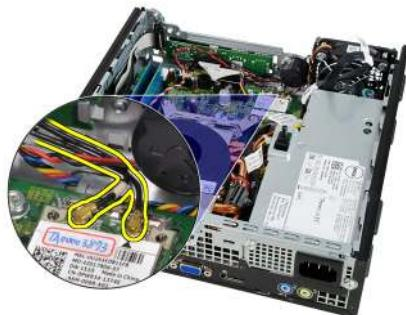
6. Wyjmij kabel anteny wewnętrznej.
