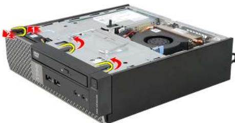
4. Odchyl pokrywę od komputera, aby zwolnić zaczepy po przeciwnej stronie pokrywy.
