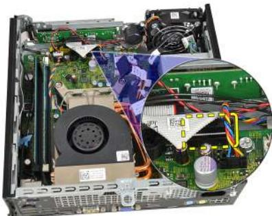
6. Vyťahnite zaistovačskrutky vstupno-výstupnej konzoly.
