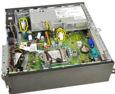
8. Lösen Sie die Schraube, die das Netzteil am Gehäuse sichert.
