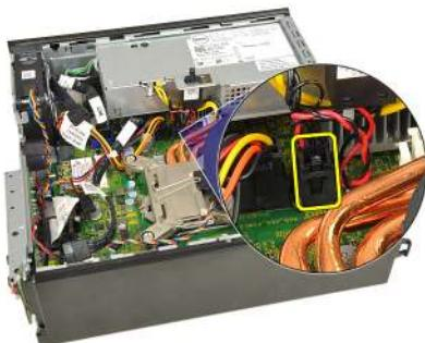
6. Vysuňte spínač proti neoprávněnému přístupu ven a vyjměte jej z držáku.
