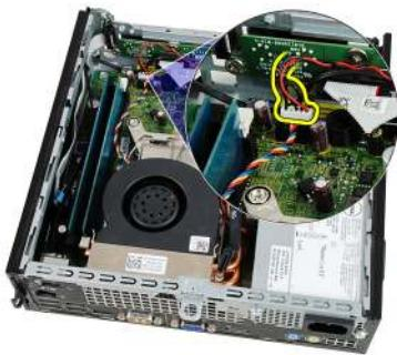
6. Wyjmij kabel głośnika spod kabla wentylatora systemowego i anten sieci WLAN (jeśli są zainstalowane).
