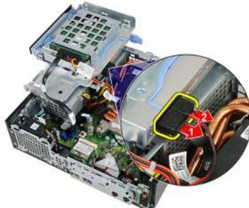
6. Odłącz kabel danych i kabel zasilania na tylnej ściance dysku twardego.
