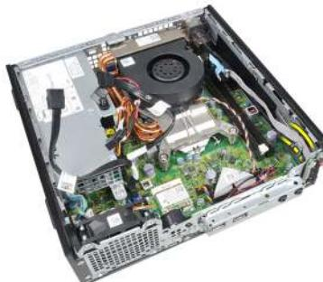
8. Entfernen Sie die Schraube, mit der die Bedienfeldplatine befestigt ist.
