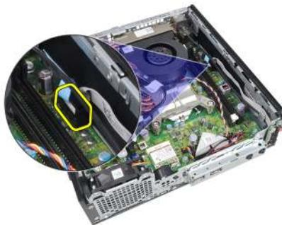
7. Lösen Sie das Lautsprecherkabel des Bedienfelds aus der Klammer am Gehäuse.
