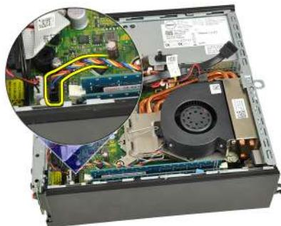
6. Drücken Sie den Entriegelungshebel herunter und bewegen Sie ihn nach außen, um ihn von dem Rückhaltehaken des Lüfters zu lösen, der ihn sichert.
