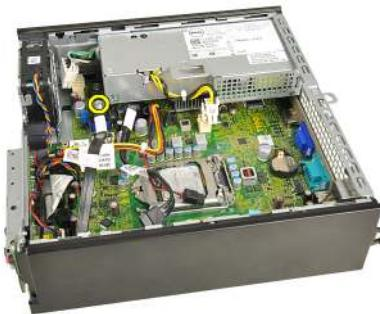
9. Demontujte šrouby, které upevňují napájecí zdroj ke skříni.
