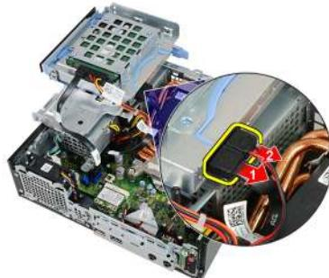
6. Trennen Sie das Datenkabel und das Stromversorgungskabel von der Rückseite des Festplattenlaufwerks.
