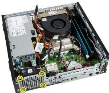
8. Heben Sie den Systemlüfter aus dem Gehäuse und entfernen Sie ihn.
