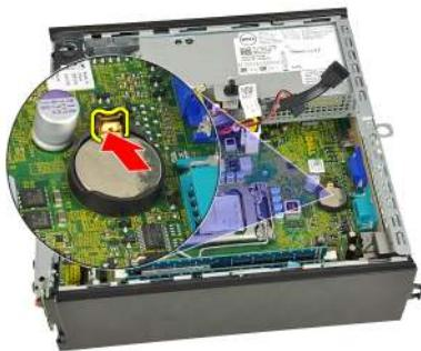
7. Vyjměte knoflíkovou baterii z počítače a odpovídajícím způsobem ji zlikvidujte.
