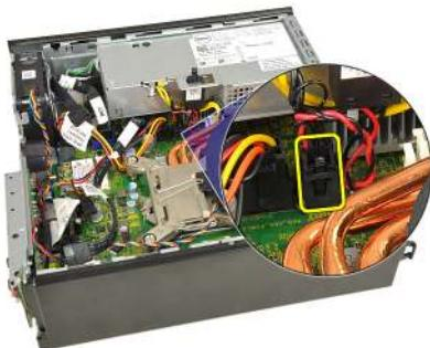
6. Schieben Sie den Eingriffschalter darüber und entfernen Sie es von der Halterung.
