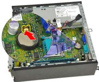
7. Nehmen Sie die Knopfzellenbatterie aus dem Computer und entsorgen Sie sie ordnungsgemäß.
