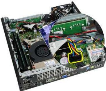
6. Lösen Sie das Kabel des Systemlüfters aus dem Gehäuse.
