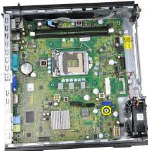
15. Schieben Sie die Systemplatine zur Vorderseite des Computers.
