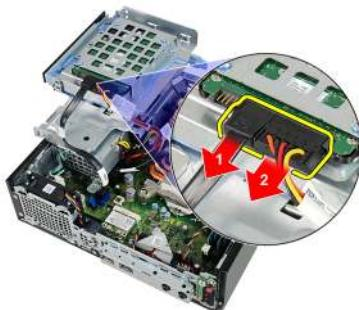
7. Entfernen Sie den Laufwerkträger aus dem System.
