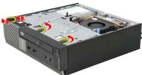
4. Drehen Sie die Verkleidung seitlich vom Computer weg, um die Haken auf der gegenüberliegenden Seite der Verkleidung aus dem Gehäuse zu entfernen.
