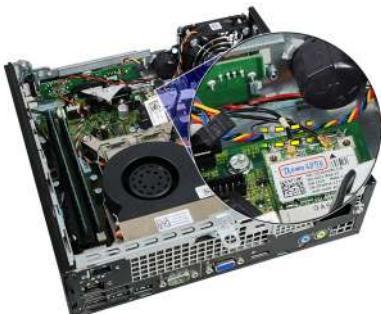
7. Demontujte šrouby, které připevňují ventilátor ke skříni.
