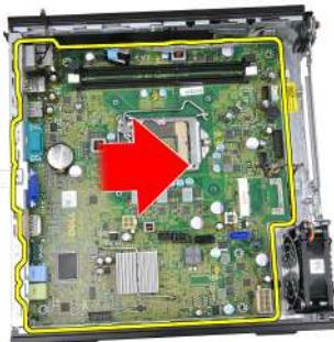
16. Entfernen Sie die Systemplatine aus dem Gehäuse.
