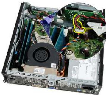
6. Vytáhněte kabel reproduktoru umístěný pod kabelem systémového ventilátoru a anténami místní sítě (WLAN) (pokud jsou nainstalovány).
