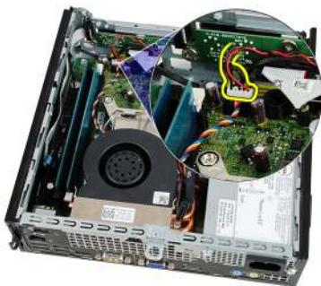
6. Húzza ki a hangszóró kábelét a rendszerhűtő kábele és a vezeték nélküli helyi hálózati (WLAN) kártya antennája alól (ha van ilyen).
