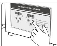
Pro spuštění přístroje nastavte dobu chodu ultrazvuku. Jedním stisknutím tlačítka "Time+" zvýšte dobu chodu o 1 minutu a stisknutím tlačítka "Time-" ji snížte o 1 minutu. Po nastavení požadované doby použijte tlačítko zapnutí/vypnutí - ultrazvuková čistička se spustí a zastaví po uplynutí nastavené doby.
