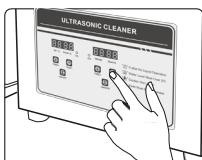
A készülék indításához állítsa be az ultrahang futási időt. Nyomja meg egyszer az "Time+" gombot a futási idő 1 perccel történő növeléséhez, és az "Time-" gombot az idő 1 perccel történő csökkentéséhez. A kívánt idő beállítása után használja a be/kí gombot - az ultrahangos tisztító elindul és a beállított idő letelte után leáll.
