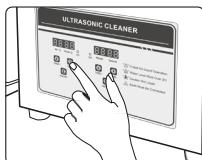
Um die Heizfunktion zu aktivieren, stellen Sie die gewünschte Temperatur ein. Drücken Sie einmal die Taste "Temp+", um die Temperatur um 1 °C zu erhöhen, und "Temp-", um die gewünschte Temperatur um 1 °C zu verringern. Sobald die gewünschte Temperatur eingestellt ist, drücken Sie die Taste "Ein/Aus". Das Heizgerät beginnt zu arbeiten und schaltet sich aus, wenn die gewünschte Temperatur erreicht ist.
