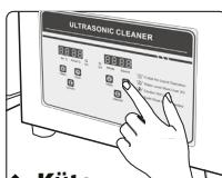
Seadme käivitamiseks seadke ultraheli tööaeg. Vajutage üks kord nuppu "Time+", et suurendada tööaega 1 minuti võrra ja "Time-", et vähendada aega 1 minuti võrra. Kui soovitud aeg on seadistatud, kasutage nuppu "sisse/välja" - ultrahelipuhasti käivitub ja seiskub pärast seadistatud aja möödumist.
