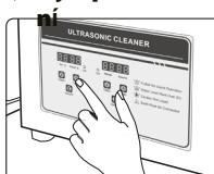
Chcete-li aktivovat funkci ohrevu, nastavte požadovanou teplotu. Jedním stisknutím tlačítka "Temp+" zvýšte teplotu o 1 °C a tlačítkem "Temp-" snížte požadovanou teplotu o 1 st. C. Po nastavení požadované teploty použijte tlačítko zapnutí/vypnutí. Ohřívač začne pracovat a vypne se po dosažení požadované teploty.
