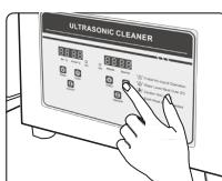
Lai iedarbinātu ierīci, iestatiet ultraskanjas darbības laiku. Nospiediet vienu reizi pogu "Time+", lai pagarinātu darbības laiku par 1 minūti, un "Time-", lai to samazinātu par 1 minūti. Kad iestatīs vēlamais laiks, izmantojiet ieslēgšanas/izslēgšanas pogu - ultraskanjas tīritājs ieslēgsies un apstāsies pēc iestātīta laika beigām.
