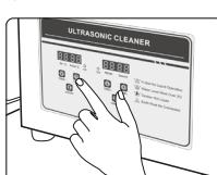
Aby włączyć funkcję grzania, należy ustawić żądaną temperaturę. Naciśnij raz przycisk "Temp+" aby zwiększyć temperaturę o 1 st C oraz "Temp-" aby zmniejszyć żądaną temperaturę o 1 st C. Po ustawieniu żąданej temperatury użyj przycisku włącz/wyłącz. Grzałka rozpocznie działanie i wyłączy się po osiągnięciu zadanej temperatury.
