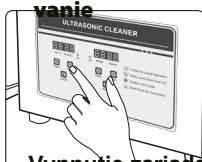
Ak chcete aktivovať funkciu ohrevu, nastavte požadovanú teplotu. Stlačením tlačidla "Temp+" raz zvýšte teplotu o 1 C a "Temp-" znížte požadovanú teplotu o 1 st C. Po nastavení požadovanej teploty použite tlačidlo zapnutia/vypnutia. Ohrievač začne pracovať a vypne sa po dosiahnutí požadovanej teploty.
