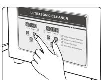
A fűtési funkció aktiválásához állítsa be a kívánt hőmérsékletet Nyomja meg egyszer a "Temp+" gombot a hőmérséklet 1 C-kal történő növeléséhez, és a "Temp-" gombot a kívánt hőmérséklet 1 C-kal történő csökkentéséhez. A kívánt hőmérséklet beállítása után használja a be/kikapcsoló gombot. A fűtőberendezés elkezd működni, és a kívánt hőmérséklet elérésekor kikapcsol.
