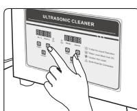
Pentru a activa funcția de încălzire, setați temperatura dorită. Apăsați butonul "Temp+" o dată pentru a crește temperatura cu 1 C și "Temp-" pentru a reduce temperatura dorită cu 1 st C. Odată ce temperatura dorită este setată, utilizați butonul on/off. Încălzitorul va începe să funcționeze și se va opri când este atinsă temperatura dorită.
