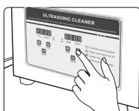
Ak chcete zariadenie spustiť, nastavte čas chodu ultrazvuku. Stlačením tlačidla "Time+" raz predĺžite čas chodu o 1 minútu a stlačením tlačidla "Time-" znížite čas o 1 minútu. Po nastavení požadovaného času použite tlačidlo zapnutia/vypnutia - ultrazvukový čistič sa spustí a zastaví po uplynutí nastaveného času.
