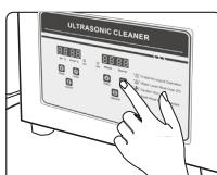
Pentru a porni unitatea, setați timpul de funcționare a ultrasunetelor. Apăsați butonul "Time+" o dată pentru a crește timpul de funcționare cu 1 minut și "Time-" pentru a reduce timpul cu 1 minut. După ce a fost setat timpul dorit, utilizați butonul pornit/oprit - aparatul de curățat cu ultrasunete va porni și se va opri după expirarea timpului setat.
