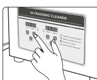
Lai aktivizētu sildīšanas funkciju, iestatiet vēlamo temperatūru Nospiediet vienu reizi pogu "Temp+", lai paaugstinātu temperatūru par 1 C, un "Temp-", lai pazeminātu vēlamo temperatūru par 1 C. Kad vēlamā temperatūra ir iestātīta, izmantojiet ieslēgšanas/izslēgšanas pogu. Sildītājs sāks darboties un izslēgsies, kad būs sasniegta vēlamā temperatūra.
