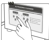
За да активирате функцията за отопление, задайте желаната температура. Натиснете веднъж бутона "Temp+", за да увеличите температурата с 1 °C, и "Temp-", за да намалите желаната температура с 1 °C. След като желаната температура е зададена, използвайте бутона за включване/изключване. Нагревателят ще започне да работи и ще се изключи, когато желаната температура бъде достигната.
