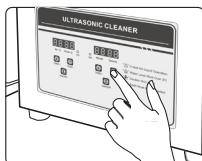
Um das Gerät zu starten, stellen Sie die Laufzeit des Ultraschalls ein. Drücken Sie einmal die Taste "Time+", um die Laufzeit um 1 Minute zu erhöhen und "Time-", um die Laufzeit um 1 Minute zu verringern. Sobald die gewünschte Zeit eingestellt ist, betätigen Sie die Ein/Aus-Taste - das Ultraschallgerät startet und stoppt nach Ablauf der eingestellten Zeit.
