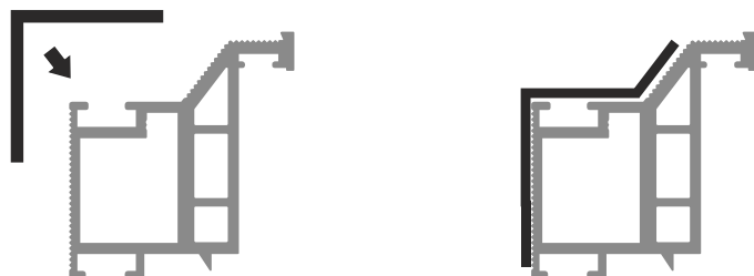
Ościeżnica typu 2 - do wewnątrz - zaślepki dogiąć do kształtu ościeżnicy w razie potrzeby.
