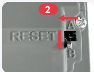
Najděte prvek RESET – je tam páčka. Posuňte tlačítko RESET doleva a dolů z polohy „A“ do polohy „B“.
