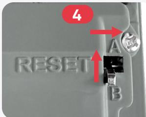
Schieben Sie den RESET-Schalter nach oben und rechts von Position „B“ zurück in Position „A“.
