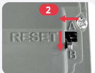
Trouvez l'élément RESET – il y a un levier à cet endroit. Déplacez le bouton RESET vers la gauche et vers le bas de la position « A » à la position « B ».
