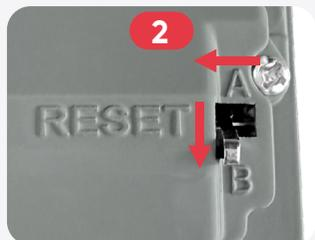
Găsește elementul RESET – acolo se află o manetă. Mută comutatorul RESET la stânga și în jos din poziția „A” în poziția „B”.
