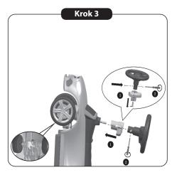
3. Przytrzymaj drążek w kształcie litery J na dole, następnie umieść część mocującą drążka zabezpieczającego i kierownicę nad drążkiem w kształcie litery J, włóż śrubę i dokręć nakrętkę śrubokrętem (brak w zestawie)
