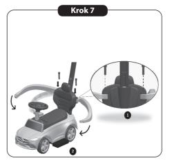
7. Zamontuj pałąk zabezpieczający w oparciu za pomocą zatrzasku kciukowego, a następnie włóż drążek zabezpieczający w otwór części stałej drążka.
