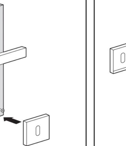
**PL:** Zamontować szyld dolny za pomocą elementów montażowych w zestawie i wcisnąć rozetę maskującą.
