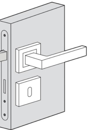
**PL:** Zamontować szyld dolny za pomocą elementów montażowych w zestawie i wcisnąć rozetę maskującą.
