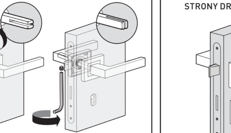
**PL:** W zależności od konstrukcji klamki i kierunku nacięcia w trzpienie zamontowanym uprzednio w zamku należy mocno dokręcić śrubę imbusową od dołu lub boku klamki.
