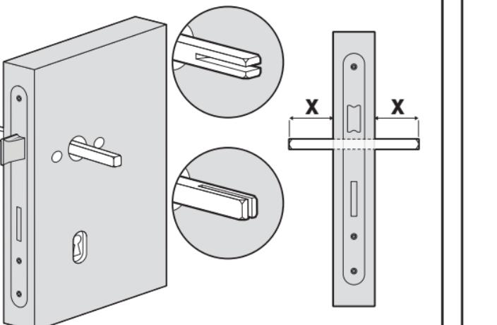
**PL:** Wsunąć trzpień symetrycznie do zamka zamontowanego w drzwiach, ustawiając nacięciem w odpowiednim kierunku w zależności od konstrukcji zastosowanej klamki.
