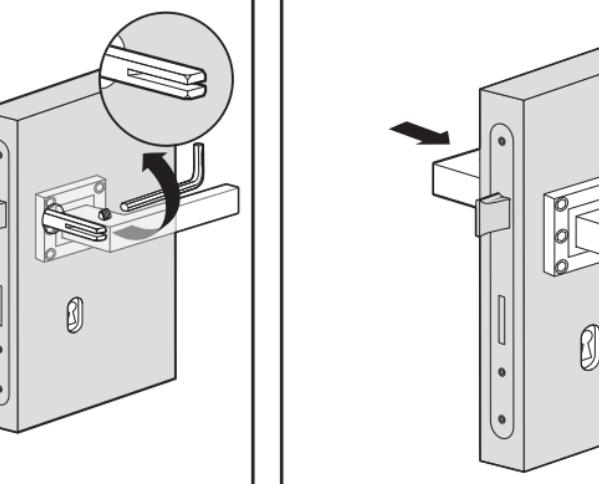
**PL:** W zależności od konstrukcji klamki i kierunku nacięcia w trzpieńiu zamontowanym uprzednio w zamku należy mocno dokręcić śrubę imbusową od dołu lub boku klamki.
