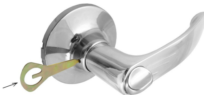
docisnąć kluczykiem blaszkę widoczną w otworze i z wycuciem wypchnąć klamkę delikatnie na zewnątrz
