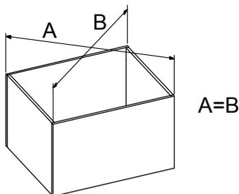
Posledným krokom je umiestnenie nábytku na správne miesto a pomocou vodováhy skontrolovaní vertikálnej a horizontálnej polohy nábytku a nastavenie čelných plôch na pántoch.
