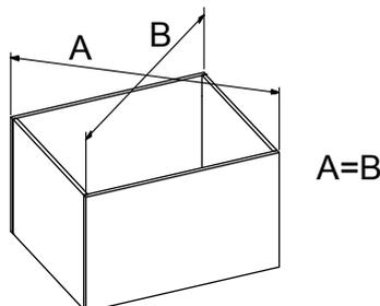
Die letzte Etappe ist das Möbels an der richtigen Stelle zu positionieren, die Lot- und Sektrechte des Möbels mit einer Wasserwaage zu prüfen und die Scharniere zu regulieren.
