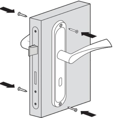
**PL:** W zależności od zawartości zestawu montażowego dokręcić dwie sztuki klamek za pomocą wkrętów do drewna lub śrub przelotowych (operacja 1.5).
