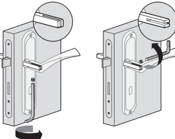
**PL:** W zależności od konstrukcji klamki i kierunku nacięcia w trzpień zamontowanym uprzednio w zamku należy mocno dokręcić śrubę imbusową od dołu lub boku klamki.
