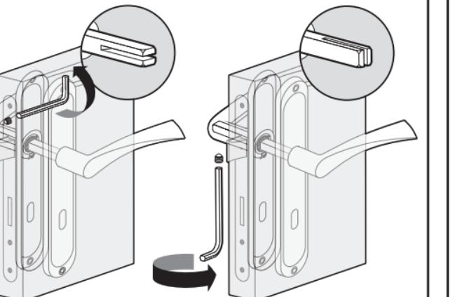
**PL:** W zależności od konstrukcji klamki i kierunku nacięcia w trzpienie zamontowanym uprzednio w zamku należy mocno dokręcić śrubę imbusową od dołu lub boku klamki.
