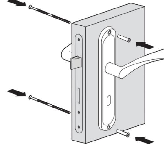
**PL:** W zależności od zawartości zestawu montażowego skrucić dwie sztuki klamek za pomocą śrub przelotowych lub wkrętów do drewna (operacja 1.6).
