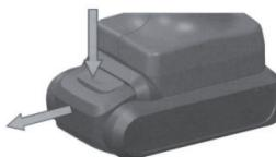
Inserimento della batteria: fare attenzione ad allineare gli slot e le linguette
