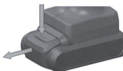
Insertion de la batterie : veillez à aligner les fentes et les languettes
