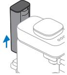
3 Entfernen Sie den Wasserbehälter von der Maschine.
