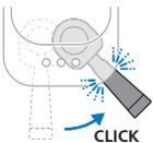
La fonction de démarrage direct vous permet d'allumer votre machine et d'infuser facilement un délicieux café. Il n'y a pas de bouton marche/arrêt. Appuyer simplement sur le bouton de la boisson que vous souhaitez préparer. Déplacer ensuite le porte-filtre vers la droite pour démarrer la mouture et le processus d'infusion.
