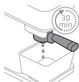
6 La machine verse toute la solution de détartrage à intervalles réguliers. Ce processus dure jusqu'à 30 minutes.
