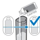
2 将半瓶（125 毫升）飞利浦 CA6700 液体除垢剂倒入水箱中。
