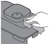
Çekirdek haznesinin içini ve makinenin dışını nemli bir bezle temizleyin. Çekirdek haznesini ve makinenin dışını kuru bir bezle kurulayın.
