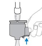
**14** Retirer le porte-filtre et le rincer sous le robinet à l'eau fraîche. Lors du rinçage, tourner le porte-filtre pour le rincer de tous les côtés et appuyer plusieurs fois sur le bouton d'éjection. Sécher ensuite le porte-filtre à l'aide d'un chiffon propre et sec.
