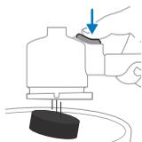
Grâce à ce bouton d'éjection, il est très facile de retirer la rondelle de café après chaque infusion. Retirer la rondelle de café en tenant le porte-filtre à l'envers et en appuyant sur le bouton d'éjection.
