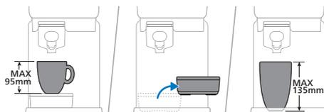
Il est possible de retirer le plateau d'égouttement pour créer de l'espace supplémentaire pour placer des tasses ou des verres plus hauts. Si le plateau d'égouttement est retiré, il est possible de placer une tasse d'une hauteur allant jusqu'à 135 mm.
