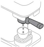
7 Het apparaat warmt op en begint water uit de koffie-uitloop in de kop te spoelen. De knop voor extra sterke koffie blijft tijdens dit proces langzaam knippen.
