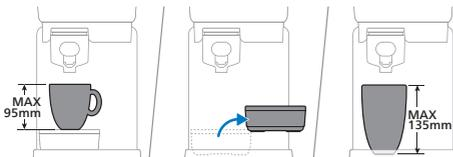
Vous pouvez placer une tasse d'une hauteur allant jusqu'à 95 mm lorsque le plateau d'égouttement est positionné. Il est possible de retirer le plateau d'égouttement pour créer de l'espace supplémentaire pour placer des tasses ou des verres plus hauts. Si le plateau d'égouttement est retiré, il est possible de placer une tasse d'une hauteur allant jusqu'à 135 mm.
