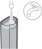
4 Spoel het waterreservoir schoon. Vul het waterreservoir met vers water en plaats het terug in het apparaat.
