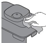
Nettoyer l'intérieur du bac à grains et l'extérieur de la machine à l'aide d'un chiffon humide.
