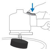
Dzięki przyciskowi wysuwania bardzo łatwo jest wyjąć krążek fusów kawy po każdym zaparzeniu kawy. Wyjmij krążek fusów kawy, trzymając kolbę spodem do góry i naciskając przycisk wysuwania.
