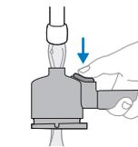
**14** Wyjmij kolbę i opłucz ją świeżą wodą pod kranem. Podczas płukania obróć kolbę, aby przepłukać ją ze wszystkich stron i kilkakrotnie naciśnij przycisk wysuwania. Następnie osusz kolbę czystą, suchą szmatką.
