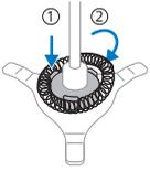
4 Placez le fouet sur son support. Placez le support du fouet et le fouet dans le mouseur à lait.
