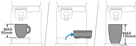
Mit eingebauter Abtropfschale kann die Tasse eine Höhe von bis zu 95 mm haben. Sie können die Abtropfschale entfernen, um zusätzlichen Platz für große Tassen oder Gläser zu schaffen. Wenn die Abtropfschale entfernt wird, kann die Tasse eine Höhe von bis zu 135 mm haben.
