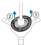
2 Nehmen Sie den Deckel ab, und entfernen Sie dann den Schneebesenhalter vom Milchaufschäumer.
