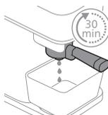
**6** Urządzenie dozuje cały roztwór odkamieniający w regularnych odstępach czasu. Trwa to do 30 minut.
