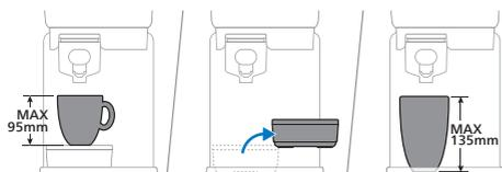
U kunt een kop met een hoogte tot 95 mm plaatsen wanneer de lekbak is geplaatst. U kunt de lekbak verwijderen om extra ruimte te creëren voor grotere koppen of glazen. Als u de lekbak verwijdert, kunt u een beker met een hoogte tot 135 mm plaatsen.
