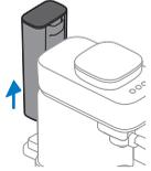
3 Retirez le réservoir d'eau de la machine.
