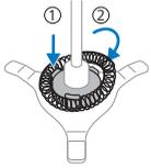
**4** Setzen Sie den Schneebesen auf den Schneebesenhalter auf. Setzen Sie den Schneebesenhalter mit dem Schneebesen in den Milchaufschäumer ein.
