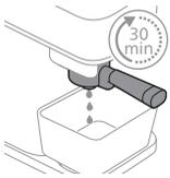
**6** Die Kaffeemaschine gibt die gesamte Entkalkungslösung in regelmäßigen Intervallen aus. Dies dauert bis zu 30 Minuten.
