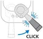
Doğrudan başlatma işlevi sayesinde makinenizin düğmesine basıp lezzetli kahveleri kolayca demleyebilirsiniz. Açma/kapama düğmesi bulunmaz. Demlemek istediğiniz içeceğin düğmesine basmanız yeterlidir. Ardından portafiltreyi sağa çevirerek öğütme ve demleme işlemini başlatın.
