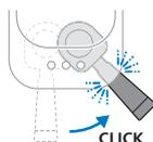
Funkcja bezpośredniego uruchamiania umożliwia łatwe włączanie ekspresu i zaparzenie pysznej kawy. Wystarczy nacisnąć przycisk napoju, który chcesz zaparzyć. Następnie należy przesunąć kolbę w prawo, aby rozpocząć mielenie i proces parzenia.
