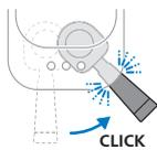
5 Déplacer fermement la poignée vers la droite jusqu'à ce qu'un « clic » se fasse entendre. La machine commencera à mouliner les grains de café pour la boisson sélectionnée dans le porte-filtre.
