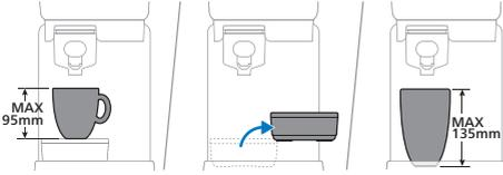
Damlama tepsi yerleştirildiğinde 95 mm yüksekliğe kadar bir fincan yerleştirebilirsiniz. Daha uzun fincanlar veya bardaklar koymak için damlama tepsisini çıkararak ekstra alan yaratabilirsiniz. Damlama tepsi çıkarıldığında 135 mm yüksekliğe kadar bir fincan yerleştirebilirsiniz.
