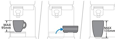
Sie können die Abtropfschale entfernen, um zusätzlichen Platz für große Tassen oder Gläser zu schaffen. Wenn die Abtropfschale entfernt wird, kann die Tasse eine Höhe von bis zu 135 mm haben.
