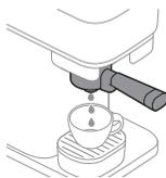
6 La machine chauffe et commence à rincer l'eau de la buse de distribution de café dans la tasse. Le bouton d'augmentation de l'intensité continue de clignoter lentement pendant ce processus.
