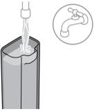
4 Rincer le réservoir d'eau. Remplir le réservoir d'eau fraîche et le remettre dans la machine.
