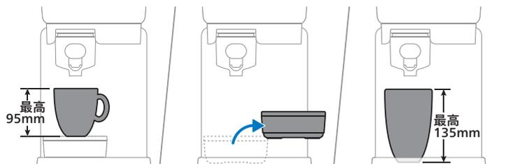
如果安装了接水盘，则可以放置一个高度不超过 95 毫米的杯子。取下接水盘，即可为高杯或玻璃杯腾出更多空间。取下接水盘之后，您可以放置一个高度不超过 135 毫米的杯子。
