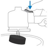
Met deze uitwerpknop kunt u eenvoudig het koffiedik na elke koffiebereiding verwijderen. Verwijder het koffiedik door het portafilter ondersteboven te houden en op de uitwerpknop te drukken.
