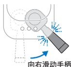
5 将手柄牢固地移到右侧，直到听到“咔哒”声。咖啡机会开始将所选饮品的咖啡豆研磨到冲煮手柄中。
