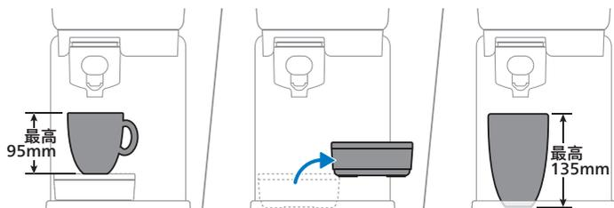
取下接水盘，即可为高杯或玻璃杯腾出更多空间。取下接水盘之后，您可以放置一个高度不超过 135 毫米的杯子。
