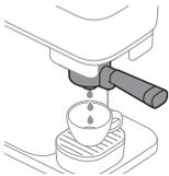
**6** La machine chauffe et commence à rincer le diffuseur avec de l'eau qui coule dans la tasse. Le bouton Booster d'intensité continuera à clignoter lentement pendant toute la durée de ce processus.
