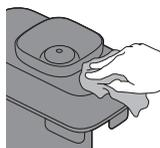
Nettoyez l'intérieur du bac à grains et l'extérieur de la machine avec un chiffon humide.
