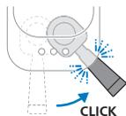
Met de functie voor onmiddellijk starten kunt u gemakkelijk uw apparaat aanzetten en heerlijke koffie zetten. Er is geen aan/uit-knop. Druk simpelweg op de knop voor de koffie die u wilt zetten. Beweeg het portafilter vervolgens naar rechts om het malen en het koffiezetten te starten.
