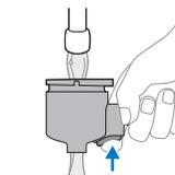
7 Lorsque le voyant d'augmentation d'intensité cesse de clignoter, le rinçage de la machine est terminé. Retirer le porte-filtre et le rincer sous le robinet avec de l'eau fraîche et tiède. Rincer soigneusement le porte-filtre de chaque côté tout en appuyant plusieurs fois sur le bouton de retrait de la rondelle.
