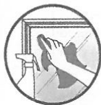
1. Oczyszczyć i odtłuścić okiennice w miejscach gdzie będzie nalepiony rzep.
