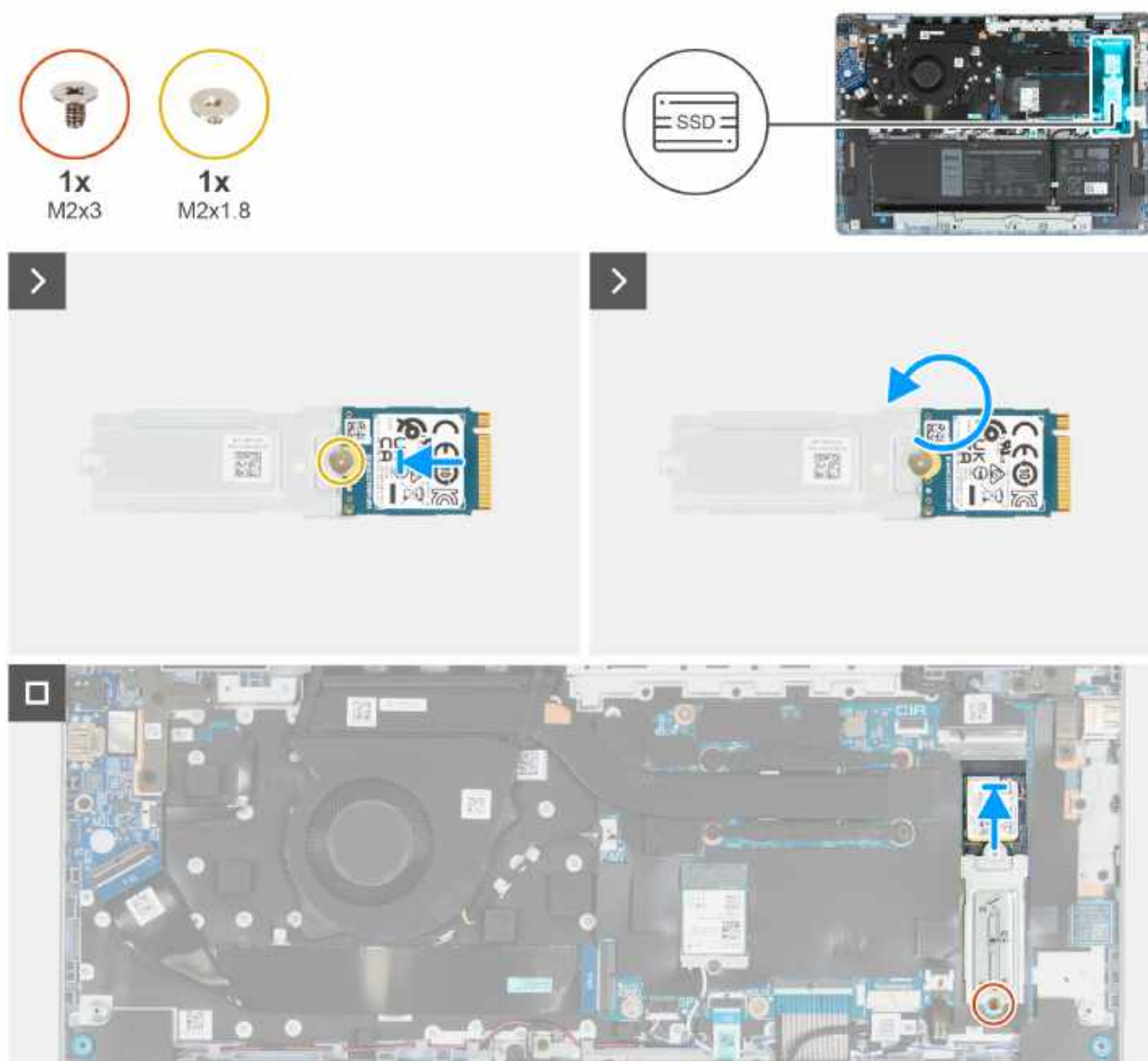
Rysunek 20. Instalowanie dysku SSD M.2 2230
