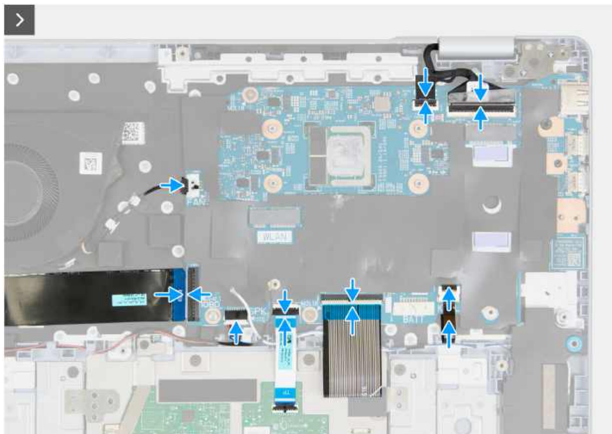
Rysunek 47. Instalowanie płyty głównej
