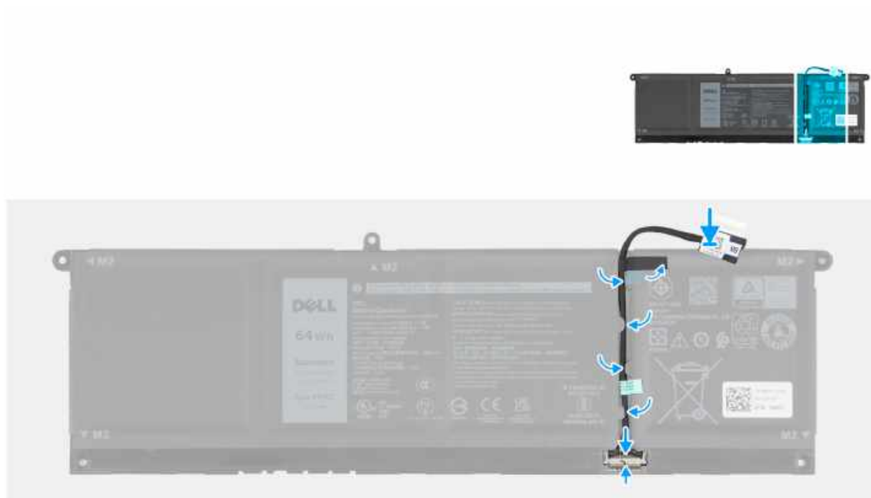
Rysunek 18. Instalowanie kabla baterii
