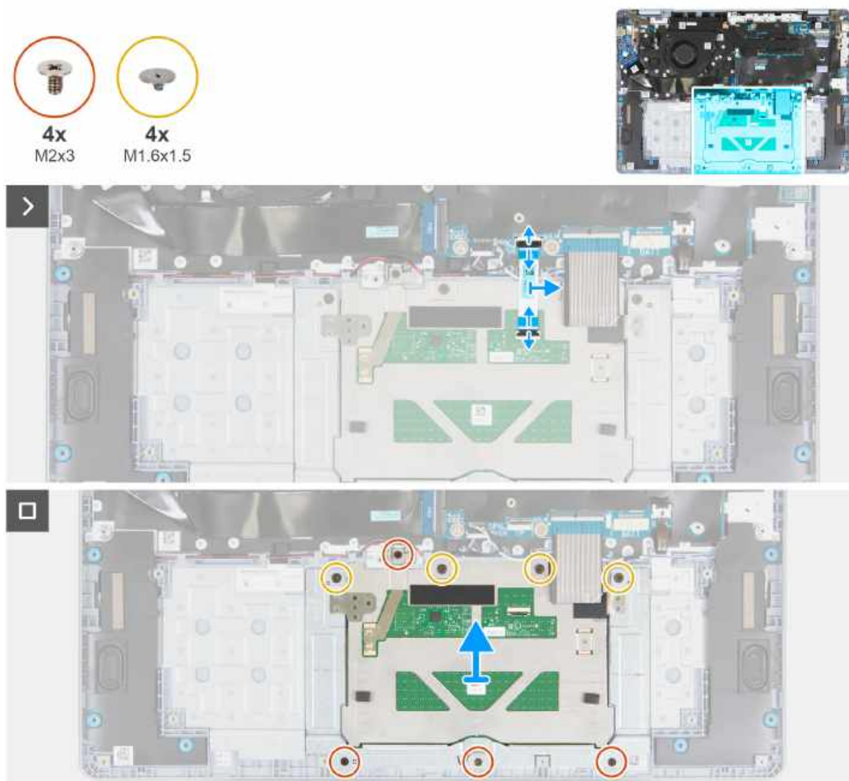
Rysunek 52. Wymontowywanie touchpada
