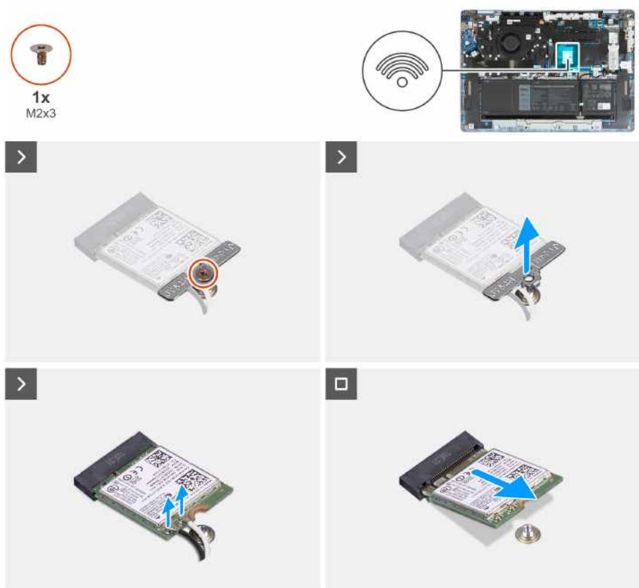
Rysunek 23. Wymontowywanie karty sieci bezprzewodowej
