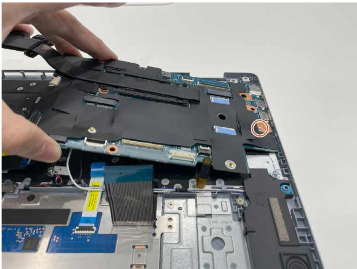
Rysunek 49. Instalowanie płyty głównej bez jej uszkodzenia
