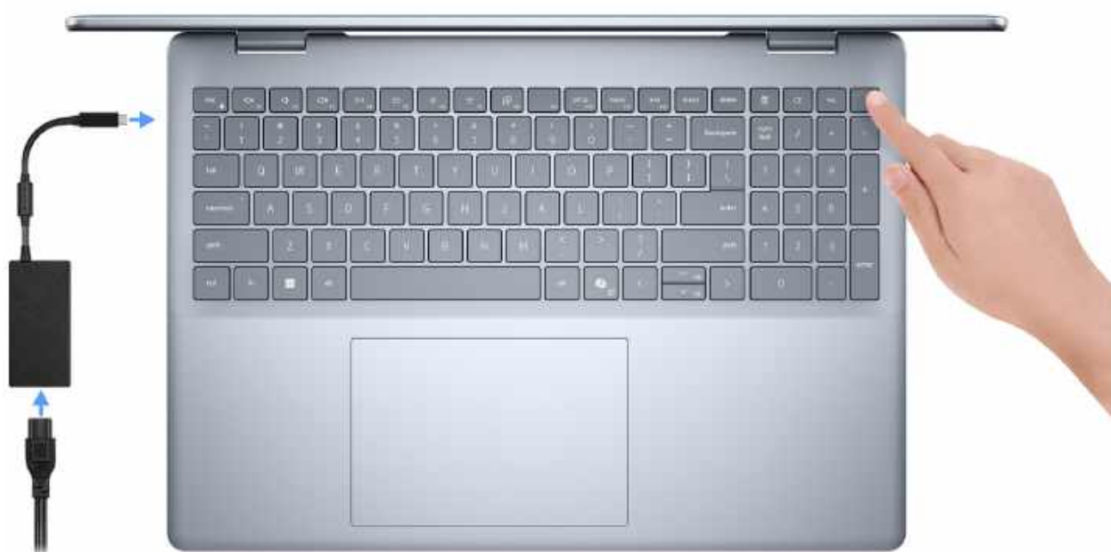
Rysunek 7. Podłącz zasilacz i naciśnij przycisk zasilania.
