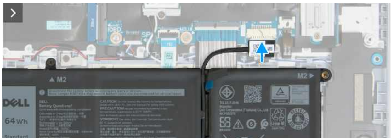
Rysunek 12. Podłączanie kabla baterii
