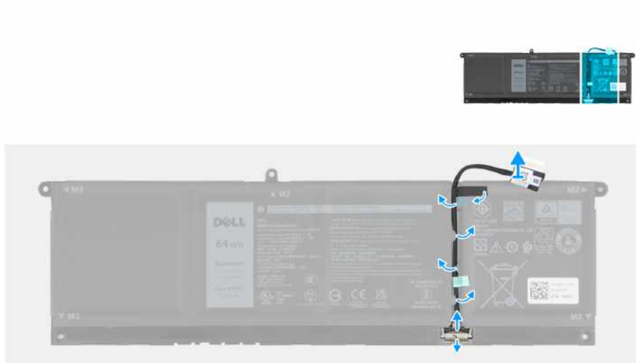
Rysunek 17. Wymontowywanie kabla baterii
