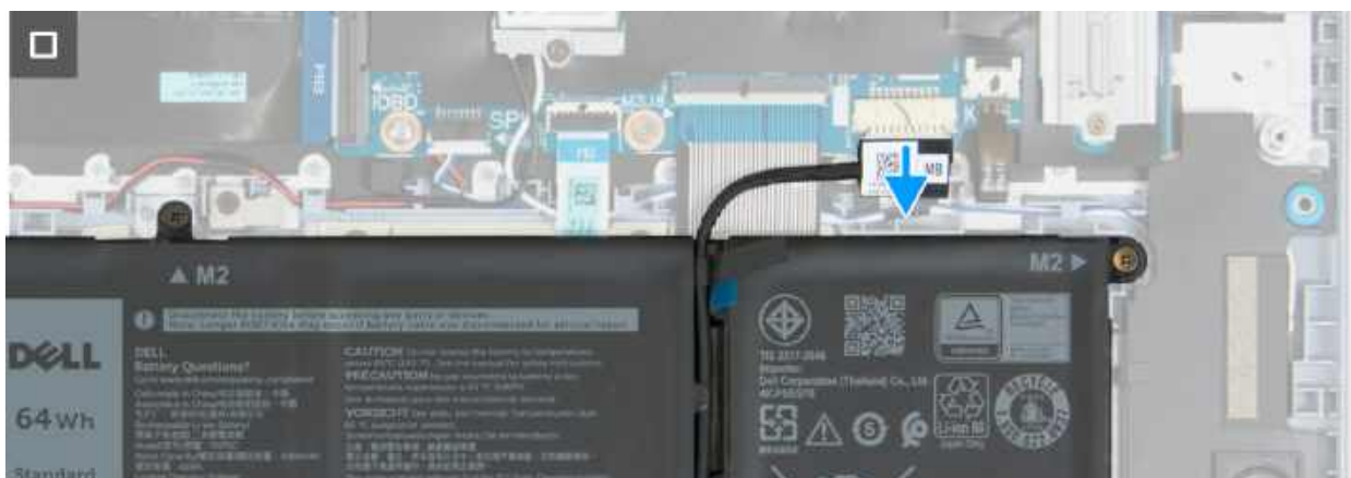
Rysunek 11. Odłączanie kabla baterii
