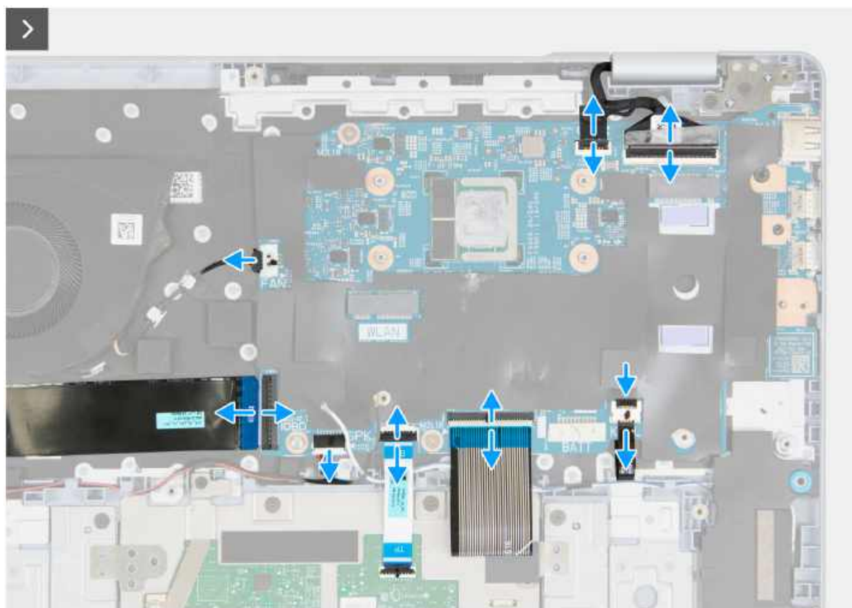
Rysunek 42. Wymontowywanie płyty głównej
