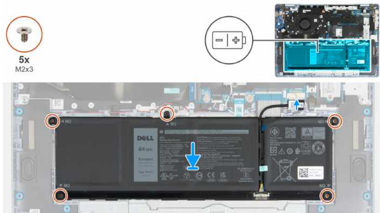
Rysunek 16. Instalowanie baterii
