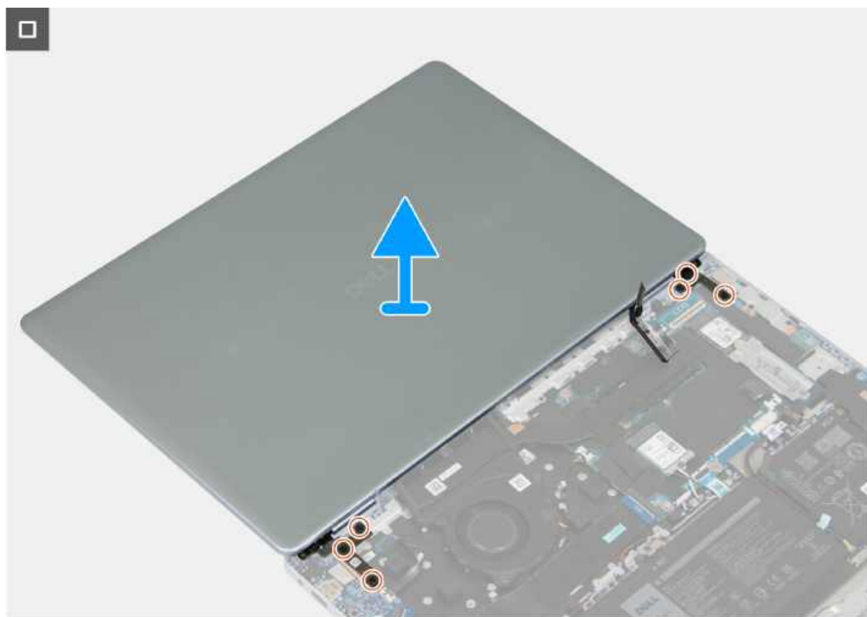
Rysunek 28. Wymontowywanie zestawu wyświetlacza — krok 2
