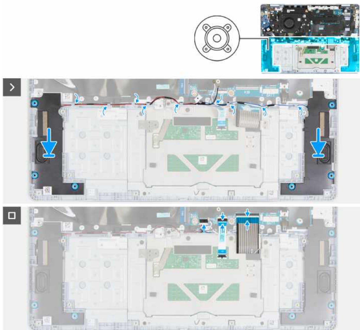
Rysunek 26. Instalowanie zestawu głośników
