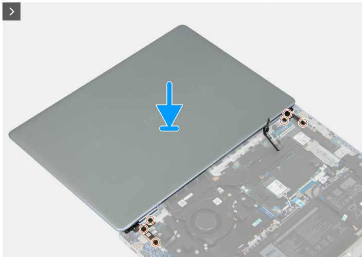
Rysunek 30. Instalowanie zestawu wyświetlacza — krok 1
