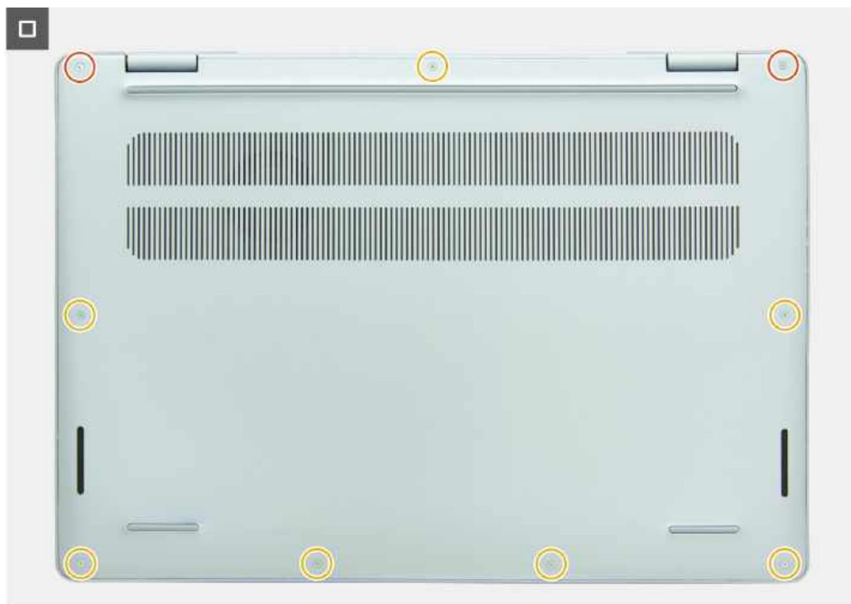
Rysunek 14. Instalowanie pokryw dolnej
