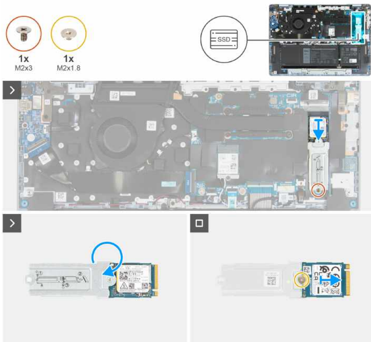
Rysunek 19. Wymontowywanie dysku SSD M.2 2230
