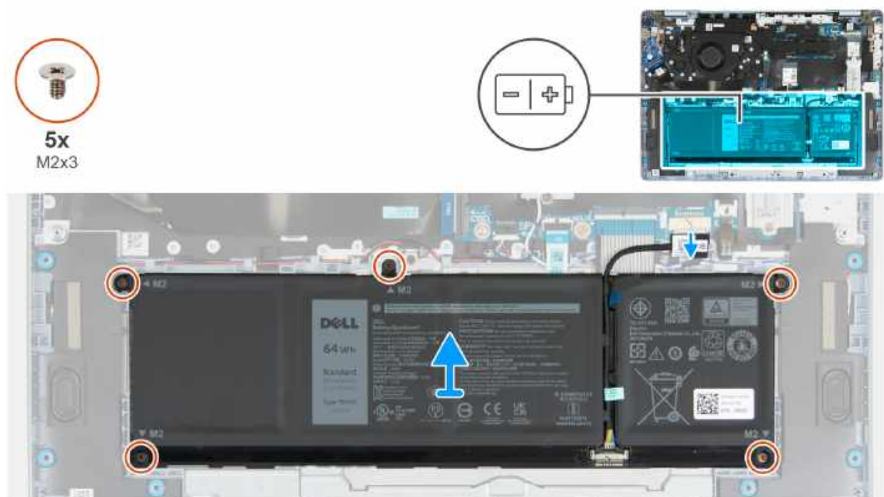
Rysunek 15. Wymontowywanie baterii
