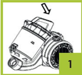
2. Drücken Sie die Sperrtaste, um den Behälter zu öffnen, dann schütten Sie den Inhalt aus.
