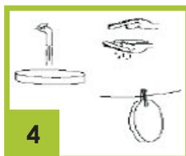
5. Aby wyczyścić filtr wylotowy powietrza, wyciągnij go z odkurzacza, następnie przepłucz w bieżącej wodzie. Wytrzyj filtr ręcznikiem papierowym i wysusz na wolnym powietrzu.
