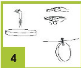
5. Um das Filter für Luftauslass zu reinigen, ziehen Sie es aus dem Staubsauger heraus und spülen Sie es unter fließendem Wasser. Wischen Sie das Filter mit dem Papiertuch ab und lassen Sie es im reien trocknen.
