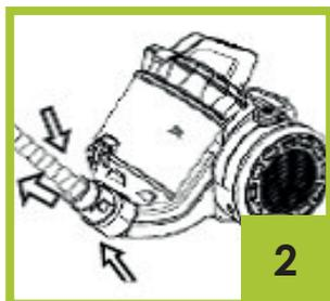
3. Łącząc rurę z węzłem, włóż większą końcówkę rury do uchwyty węża i przekręć, aby łączenie było mocne.
