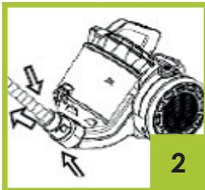
3. Wenn Sie das Staubsaugerrohr mit dem Schlauch verbinden möchten, stecken Sie den größeren Aufsatz in Schlauchhalterung ein und drehen Sie ihn für eine stärkere Verbindung.
