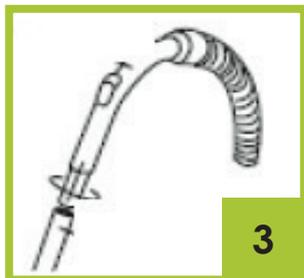
4. Aby połączyć rurę z nakładkami, włóż mniejszą końcówkę rury do nakładki i przekręć, aby łączenie było mocne.
