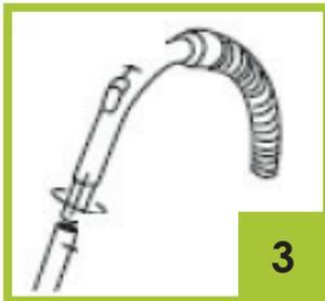
4. Um das Staubsaugerrohr mit den Aufsätzen zu verbinden, stecken Sie den kleineren Aufsatz vom Staubsaugerrohr in Aufsatz ein und drehen Sie ihn für eine stärkere Verbindung.
