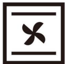
Ventilator, onder- en bovenverwarmers aan
