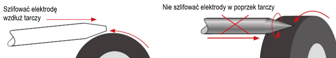
Rys. 16. Szlifowanie elektrody wolframowej
