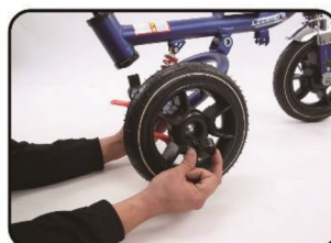
Założ plastikową osłonę osi koła
