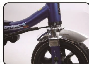
Przymocuj pręt sterujący do widełca
